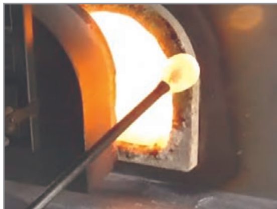
شکل ۹- برداشت بار از حوضچه بارگیر
