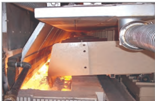
شکل ۱۷- دریچه بارریز کوره‌های شیشه تخت
