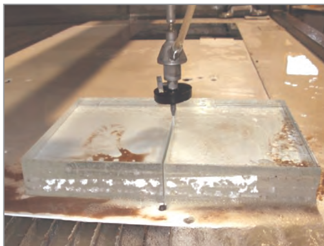
شکل ۳۱- برش شیشه با واترجت
