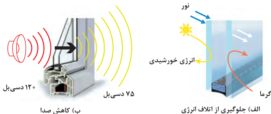
شکل ۴۲- عایق حرارتی و صوتی شیشهٔ دو جداره
