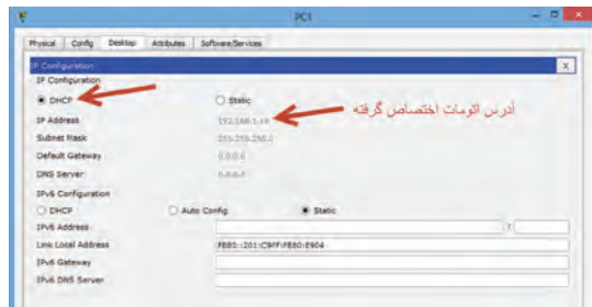
شکل ۳۰- تنظیم آدرس IP سرویس‌گیرنده‌ها در حالت خودکار
