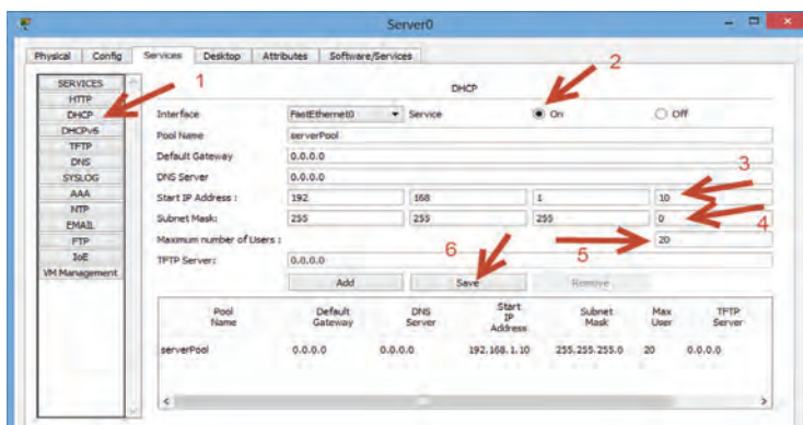
شکل ۲۹- تنظیمات سرویس DHCP روی سرور
