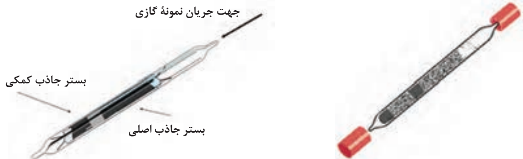
شکل ۲۰- لوله جذب سطحی حاوی زغال فعال
