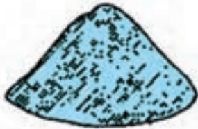
۱- دانه ها مخلوط می شوند و سپس به شکل مخروط در می آیند.
