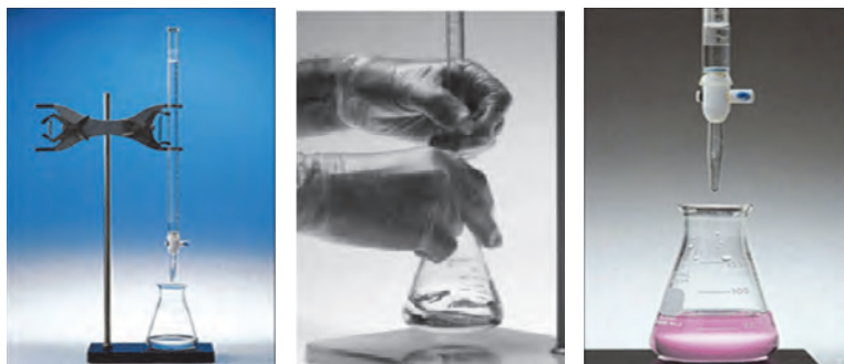
شکل ۱۰- طرح ساده‌ای از آزمایش سنجش حجمی
