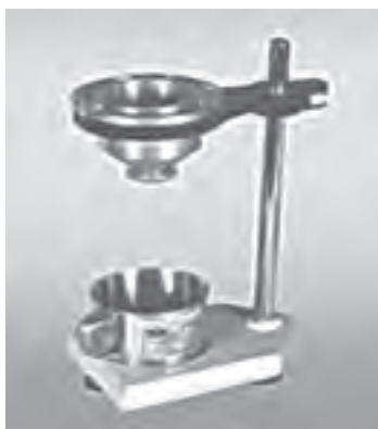
شکل ۱۶- فنجان‌های مختلف اندازه‌گیری گران روی
