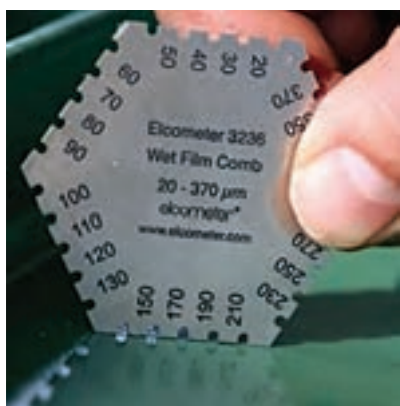
شکل ۱۹- شانۀ مخصوص اندازه‌گیری ضخامت فیلم تر رنگ
