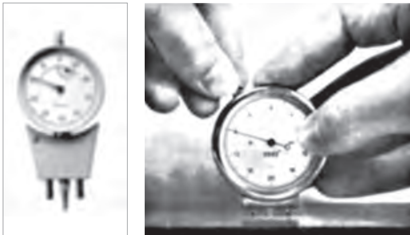
شکل ۲۱- ضخامت‌سنج فیلم خشک رنگ (روش تخریبی)
