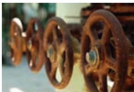
شکل ۵- نمونه‌هایی از خوردگی در قطعه‌های فلزی
