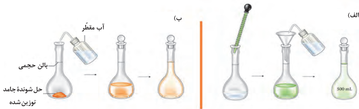
شکل ۱- تهیه محلول با نرمالیتة مشخص از (الف) نمونه مایع (ب) نمونه جامد
