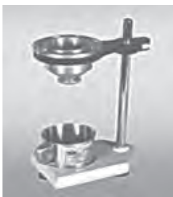
شکل ۱۶- فنجان‌های مختلف اندازه‌گیری گرانروی
