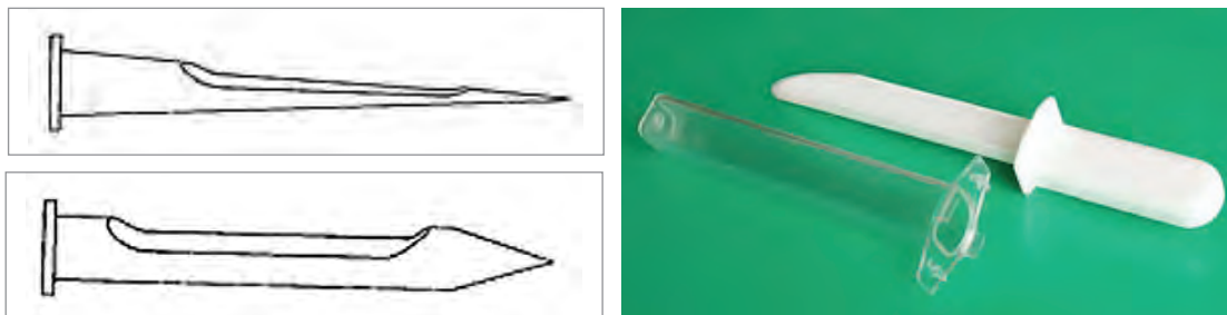
شکل ۶- لوله های نمونه گیری جامدات
