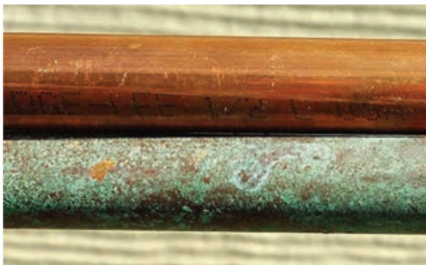
شکل ۲۹- تغییر رنگ لوله مسی در مجاورت هوای مرطوب
