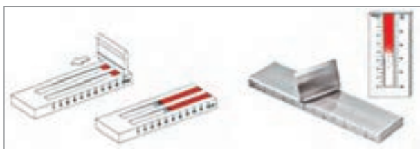
شکل ۱۷- وسیلهٔ اندازه‌گیری دانه‌بندی رنگ تر
