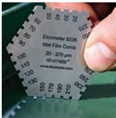
شکل ۱۹- شانه مخصوص اندازه‌گیری ضخامت فیلم تر رنگ
