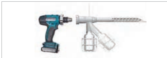
شکل ۹- نمونه گیرهای پیچی
