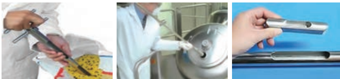
شکل ۸- نمونه گیرهای مخروطی
