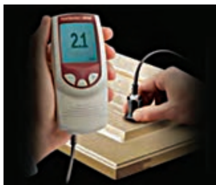
شکل ۲۲- انواع ضخامت‌سنج فیلم خشک رنگ (غیرتخریبی)
