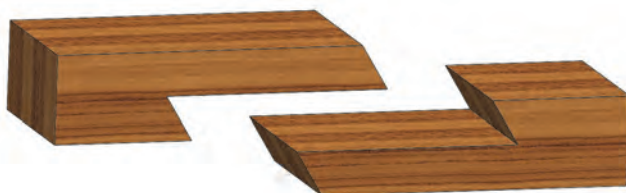
شکل ۳۸- اتصال طولی نیم و نیم
