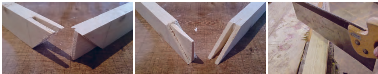
شکل ۲۰- برشکاری اتصال دو رو فارسی
