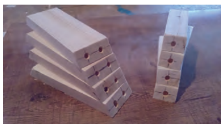
شکل ۳۳- سوراخ کردن قیدها تحت زاویه
