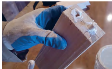
شکل ۳۵- چسب زدن اتصال دوپل
