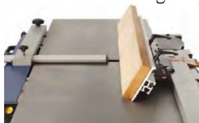
شکل ۲۳- ب) نحوه تنظیم گونیا برای رندیدن تحت زاویه
