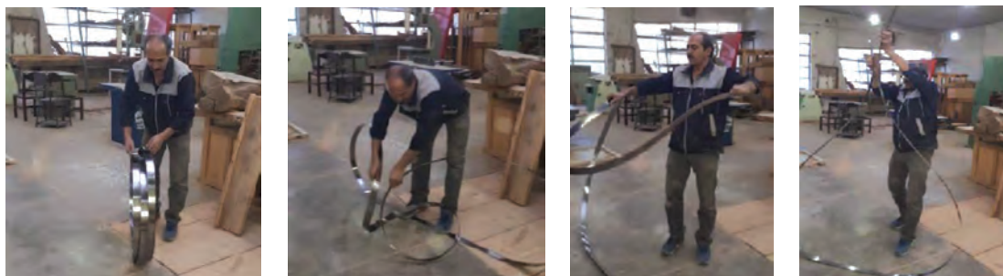
شکل ۱۹- روش جمع کردن تیغه اره نواری
