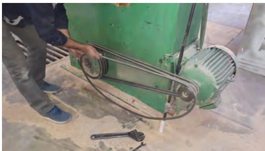
شکل ۶۰- تعویض و جایگزین کردن تسمه
