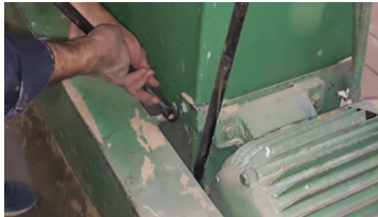
شکل ۵۹- روش باز کردن حفاظ و بررسی تسمه
