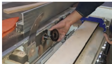
شکل ۶۲- باز کردن مهره و فلنج جلوی تیغه
