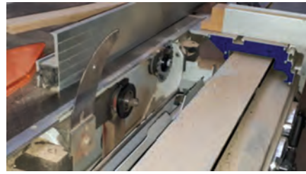
شکل ۶۳- بررسی فلنج پشت تیغه ااره
