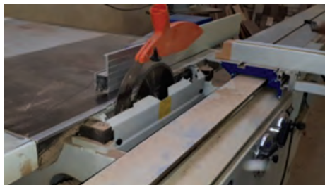
شکل ۶۷- بستن حفاظ و کاور روی تیغه ااره
