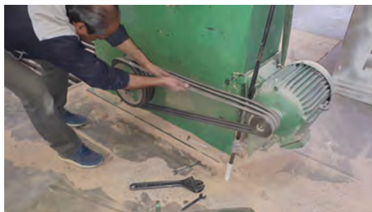
شکل ۶۰- تعویض و جایگزین کردن تسمه
