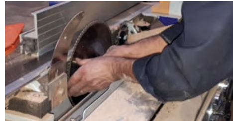
شکل ۶۵- بستن تیغه نو و نصب فلنج جلوی تیغه ااره
