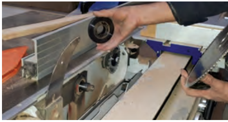
شکل ۶۳- بررسی فلنج پشت تیغه ااره
