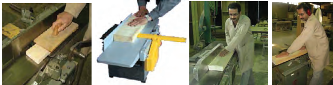
شکل ۲۹- نحوه رندیدن صحیح قطعه کار چوبی
