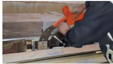
شکل ۶۷- بستن حفاظ و کاور روی تیغه ااره
