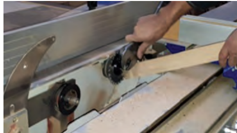
شکل ۶۴- باز کردن و بررسی تیغه خط زن
