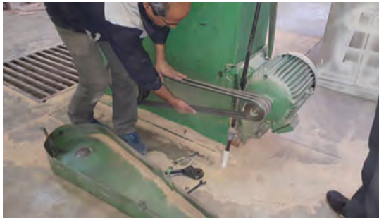
شکل ۵۹- روش باز کردن حفاظ و بررسی تسمه
