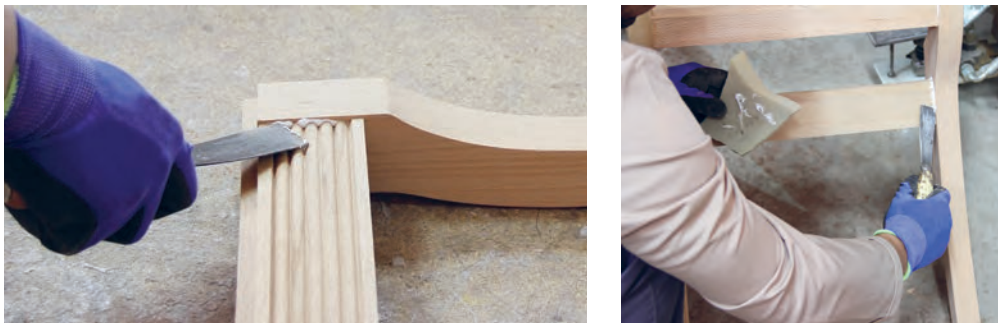
شکل ۶۷- تمیز کردن چسب اضافی با کاردک
