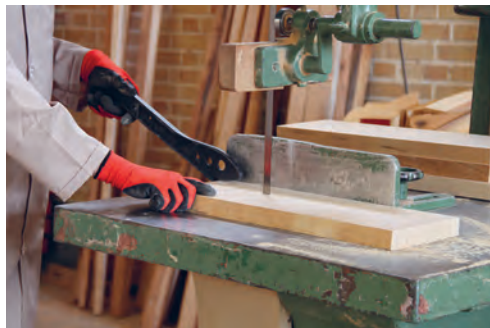
شکل ۴۰- وضعیت برش چوب قیدها
