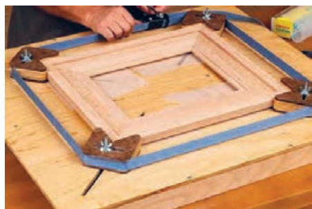
شکل ۷۲- گیره مخصوص بستن قاب
