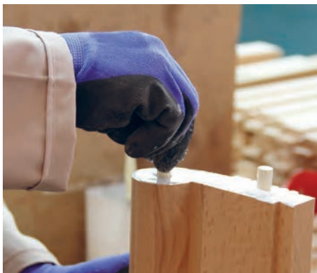
شکل ۷۰- چسب زدن و جا زدن دوبل‌ها (میخ چوبی)
