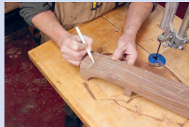
شکل ۴۷- خط کشی دوباره روی چوب
