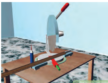
شکل ۷۳- اندازه‌گیری و برش زهوار دور میز عسلی
