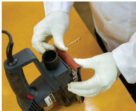
شکل ۴۴- روش جازدن سنباده
