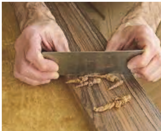
شکل ۵۵- لیسه کشی در جهت الیاف
