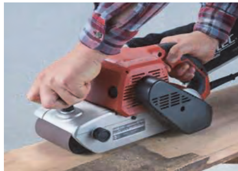
شکل ۴۸- سنباده کاری تخته‌های پهن
