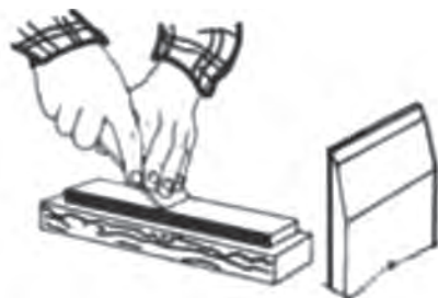
شکل ۲- تیز کردن مغار با سنگ نفت
