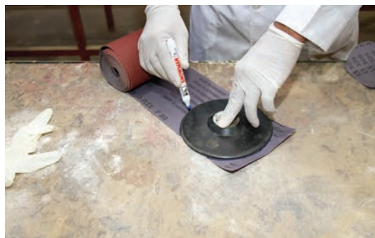
شکل ۲۹- ترسیم گردی دیسک روی سنباده
