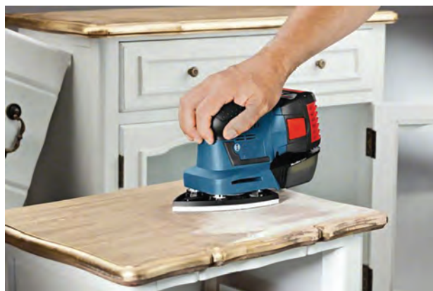
شکل ۳۳- فشار یکنواخت به سطح کار
