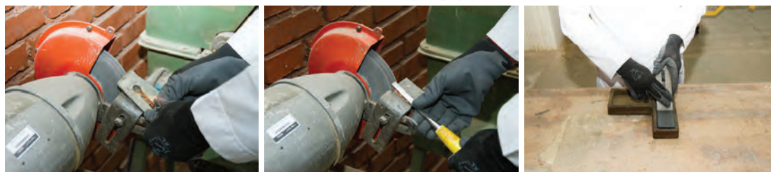
شکل ۳- تیز کردن تیغه رنده به صورت اصولی
