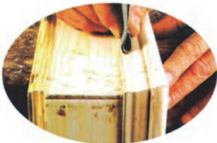
شکل ۱۴- سنباده کاری روی سطوح محدب و مقعر
