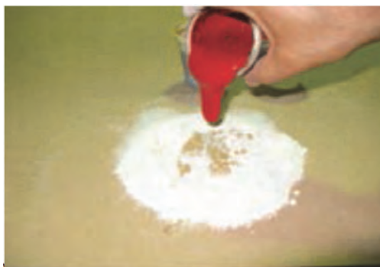
شکل ۷۹- اضافه نمودن روغن الیف به بتونه روغنی
