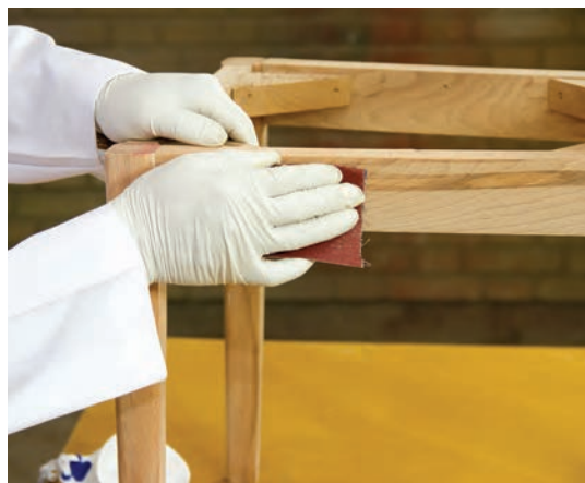
شکل ۱۲- سنباده کاری در جهت الیاف
