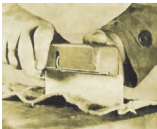
شکل ۶۲- مصقل کشی در لیسسه با رنده مصقل
