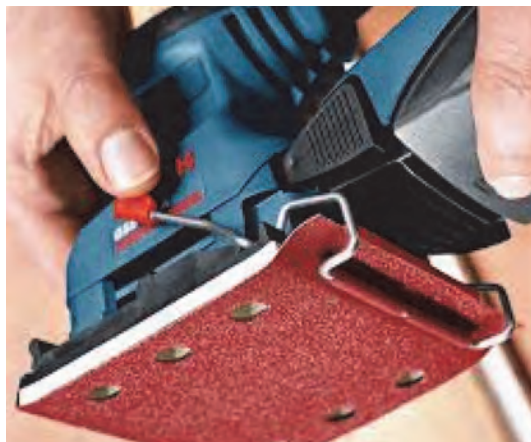
شکل ۴۳- کاغذ سنباده سوراخ‌دار
