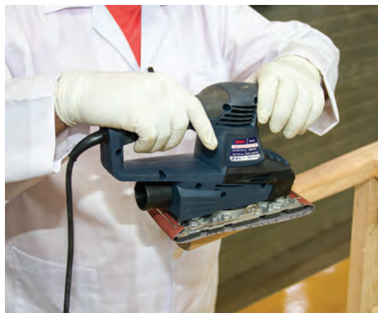
شکل ۴۶- سنباده کاری در جهت الیاف
