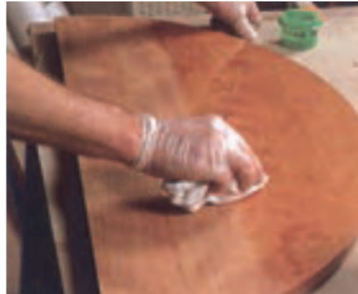
شکل ۵۷- استفاده از پارچه نم‌دار در لیسسه‌کاری
