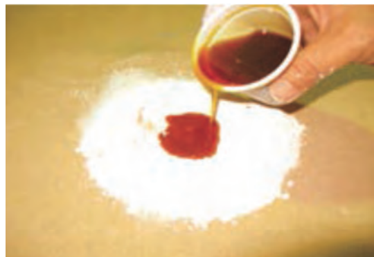
شکل ۸۳- استفاده از روغن اسکاتیف به جای روغن الیف
