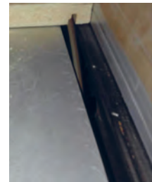
شکل ۷۴- ایجاد شیار به عمق ۸ و پهنای ۵ میلی متر برای قرارگیری آینه
