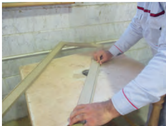
شکل ۷۴- ایجاد شیار به عمق ۸ و پهنای ۵ میلی متر برای قرارگیری آینه
