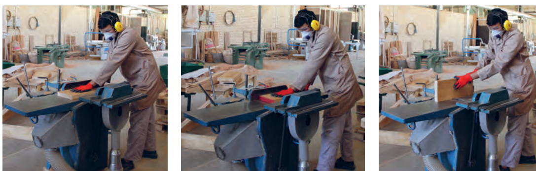
شکل ۷۰- یک رو و یک نرکردن چوب
