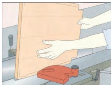
پرداخت کردن کفی با دستگاه کفرند
