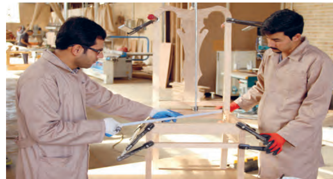
شکل ۱۰۹- کنترل دوئیدگی با متر
