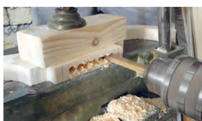
شکل ۸۸- عملیات کم کنی با دستگاه سه کاره
