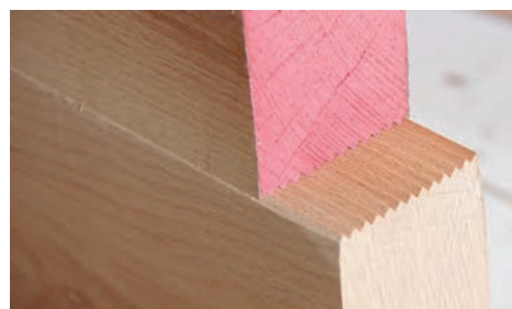
شکل ۱۳- اتصال انگشتی ساخته شده با دستگاه فرز
