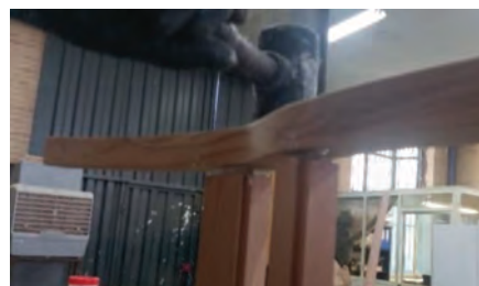
شکل ۴۹- استفاده از چکش پلاستیکی برای جا زدن قطعات
