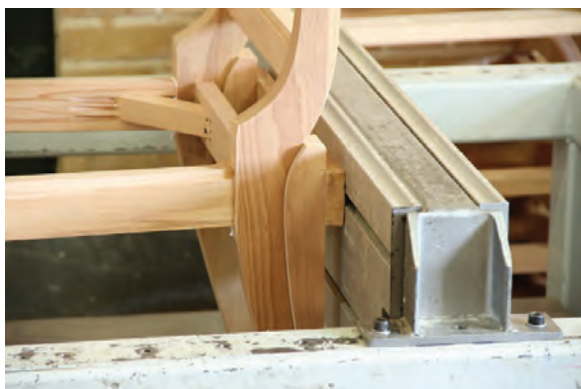
شکل ۵۵- جا زدن اتصالات با تنگ پنوماتیکی
