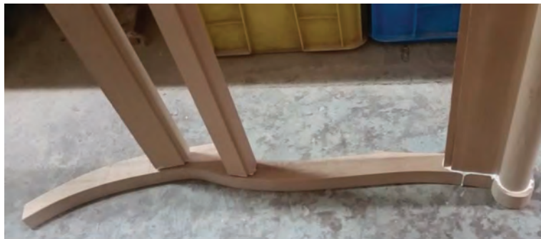
شکل ۴۸- جا زدن پشتی مبل
