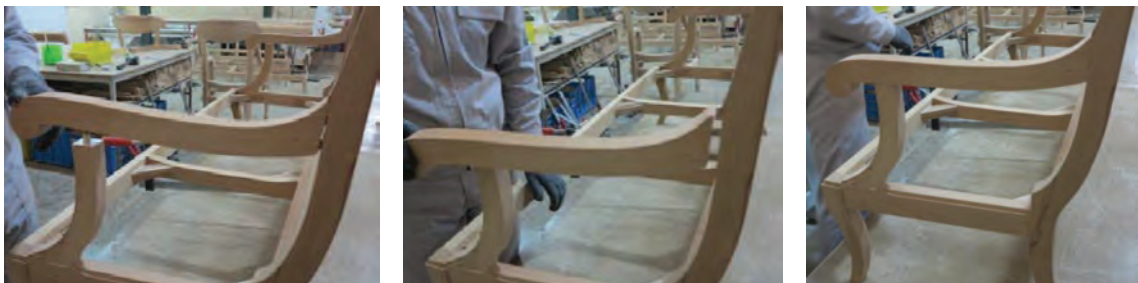
شکل ۶۱- کنترل صحیح بودن دسته مبل
