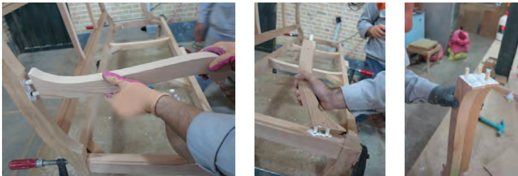
شکل ۶۰- جا زدن دسته مبل در محل اتصالات
