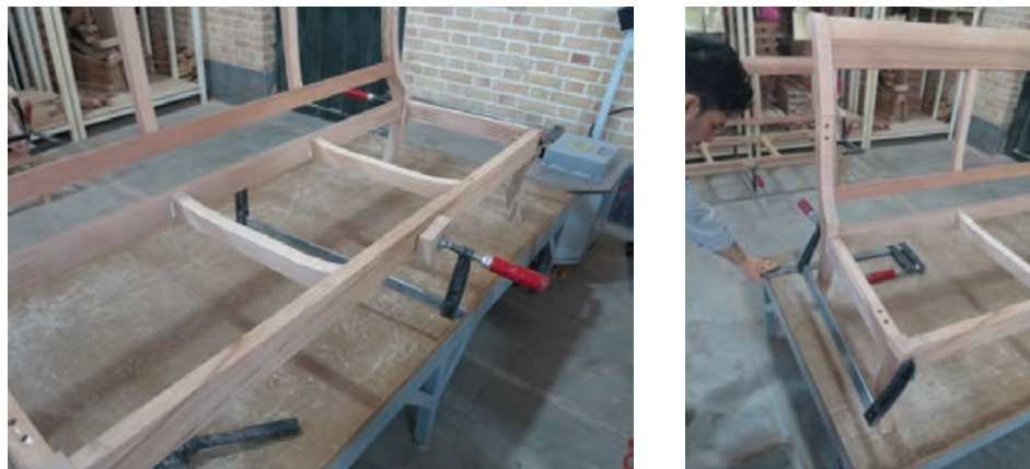
شکل ۵۶- جا زدن اتصالات با گیره دستی
