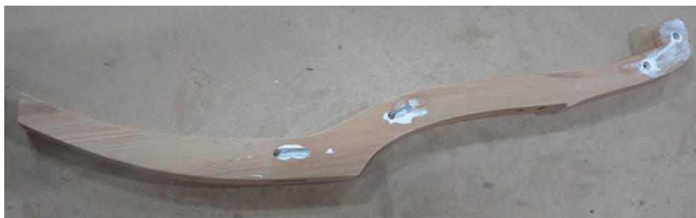
شکل ۴۶- روش چسب زدن اتصال دوبل پایه‌های عقب
