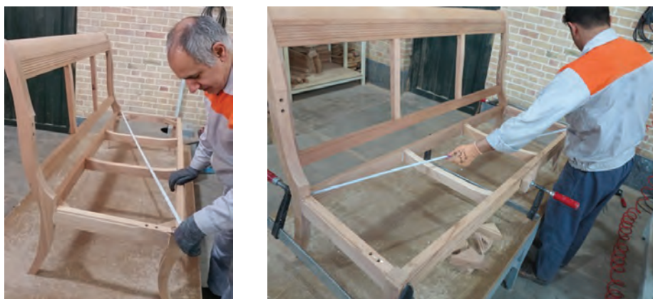
شکل ۵۷- کنترل دوئیدگی (گونیا)ی کردن کار) با متر
