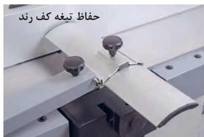
شکل ۳- نمونه‌هایی از حفاظ‌های مخصوص تیغه هر دستگاه
