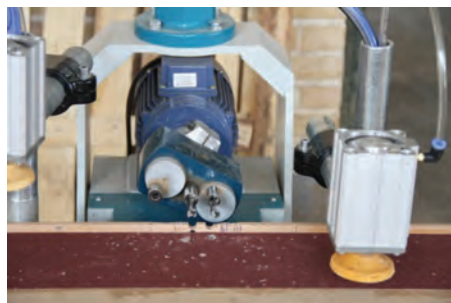
شکل ۳۸- ایجاد اتصال با دستگاه دوپل زن نیمه‌اتوماتیک
