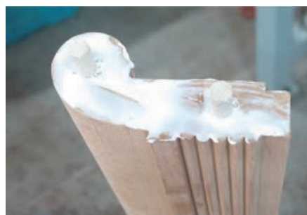
شکل ۴۶- روش چسب زدن اتصال دوبل پایه‌های عقب
