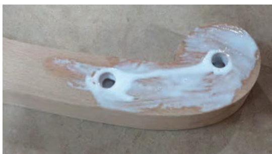
شکل ۴۶- روش چسب زدن اتصال دوبل پایه‌های عقب
