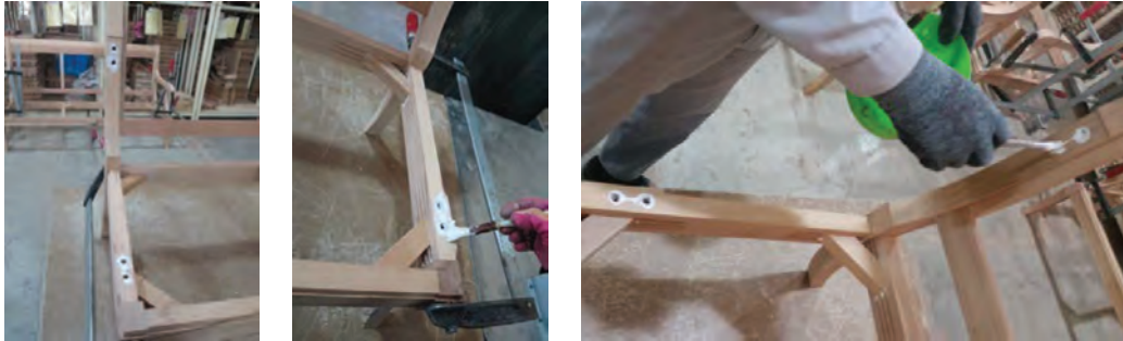
شکل ۵۹- چسب زدن محل اتصالات دسته مبل
