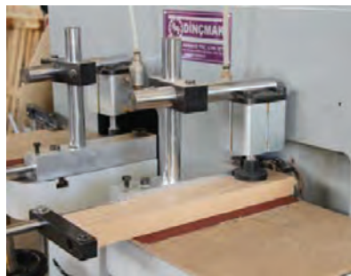
شکل ۴۲- ساخت زبانه با دستگاه زبانه‌زن نیمه‌اتوماتیک
