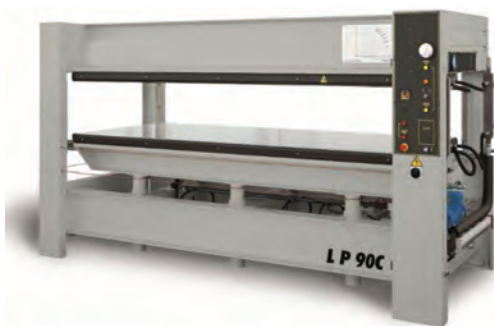
شکل ۳۹- پرس گرم یک طبقه
