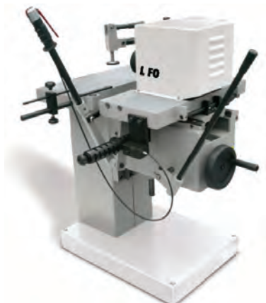
شکل ۳۷- نمونه‌ای از ماشین کم‌کن مته‌ای افقی
