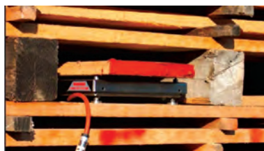
شکل ۵۹- نمونه کنترل در کوره
