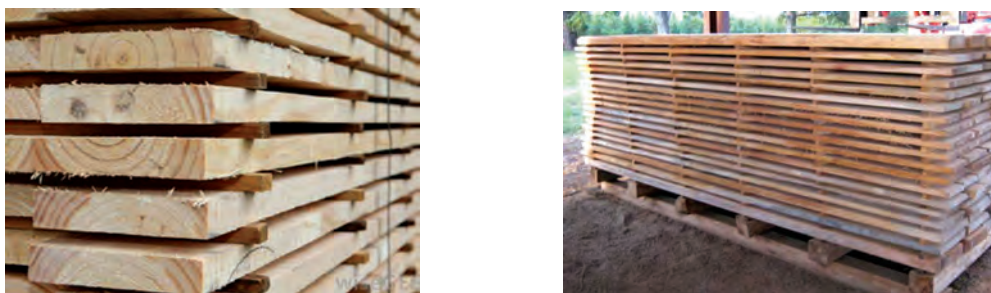
شکل ۱۳- روش چوب‌دستک گذاری در دسته‌های چوب
