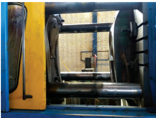
شکل ۷۴- قالب‌های مورد استفاده در ساخت مبل پلیمری
