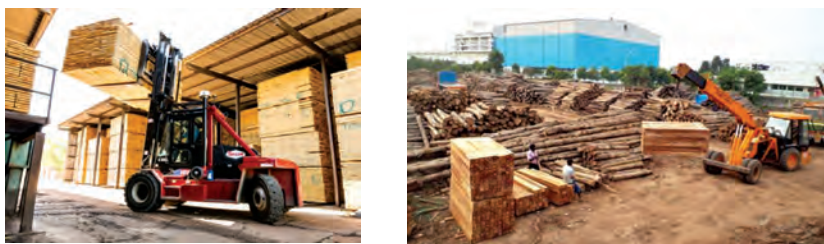
شکل ۱۶- جابه جا کردن واحد دسته بندی به وسیله لیفتراک (سمت چپ) و جرثقیل (سمت راست)
