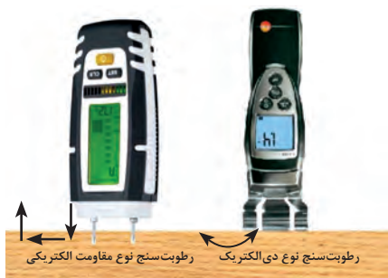
شکل ۸- روش کار رطوبت سنج های الکتریکی
