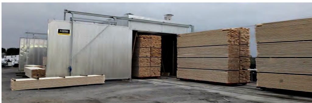
شکل ۶۵- بارگیری دسته‌بندی‌های چوب به طریق طولی
