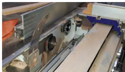
شکل ۶۳- بررسی فلنج پشت تیغه اره
