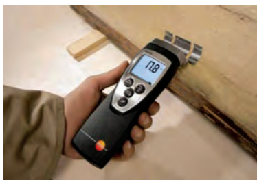
شکل ۶- دستگاه رطوبت سنج نوع دی الکتریک
