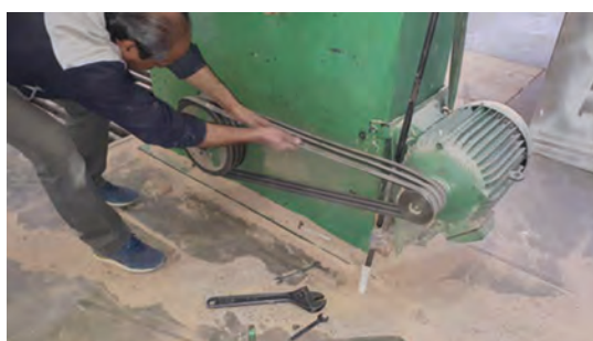
شکل ۶۰- تعویض و جایگزین کردن تسمه
