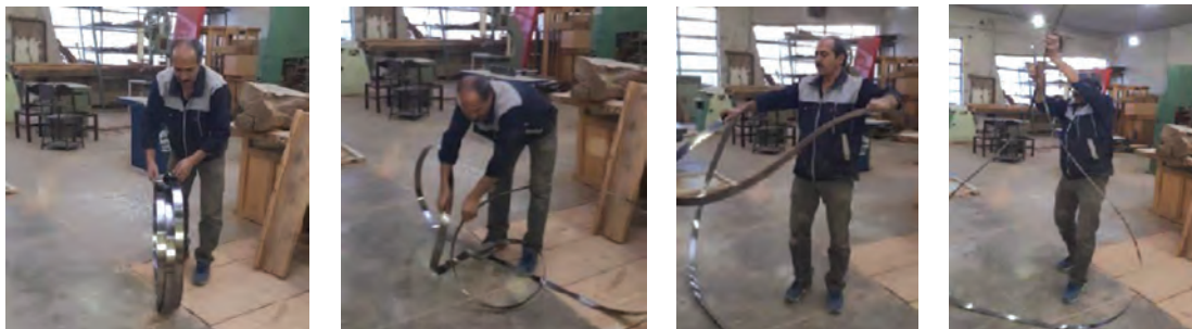
شکل ۱۹- روش جمع کردن تیغه اره نواری
