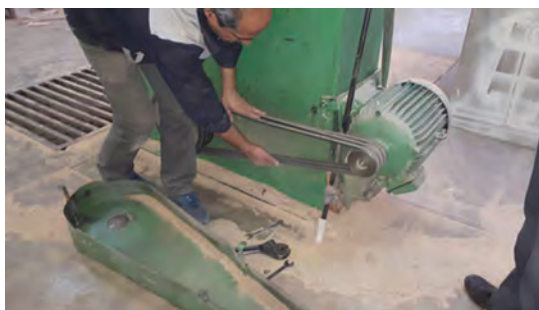
شکل ۵۹- روش باز کردن حفاظ و بررسی تسمه
