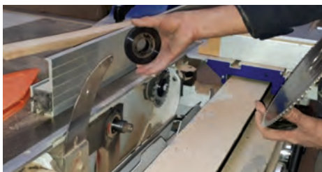
شکل ۶۳- بررسی فلنج پشت تیغه اره
