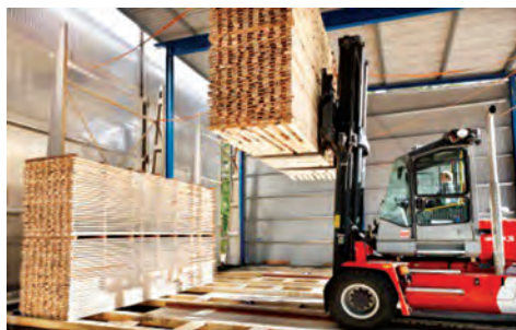
شکل ۲۳- سیستم بارگیری کوره به وسیله لیفت‌تراک
