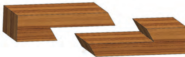
شکل ۳۸- اتصال طولی نیم و نیم
