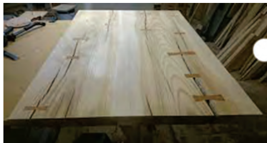
شکل ۶- اتصال دم چلچله پروانه‌ای
