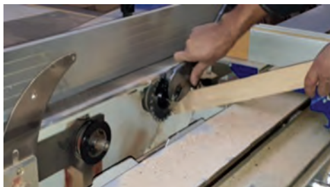
شکل ۶۴- باز کردن و بررسی تیغه خط زن
