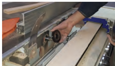
شکل ۶۲- باز کردن مهره و فلنج جلوی تیغه
