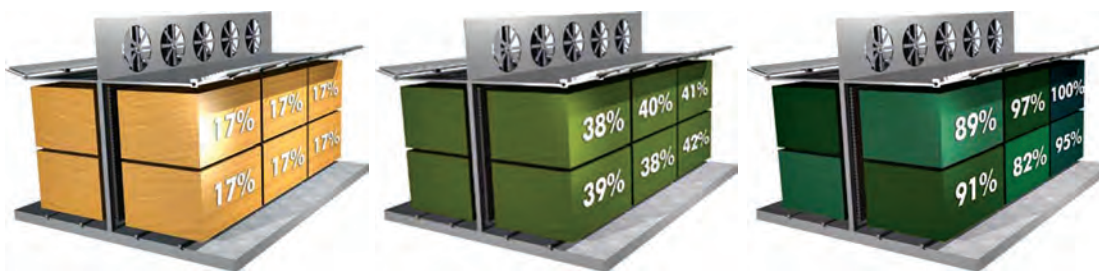
شکل ۶۸- مراحل مختلف خشک کردن چوب در کوره
