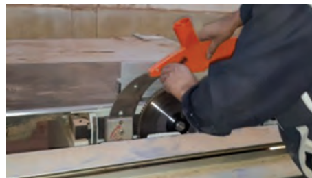
شکل ۶۷- بستن حفاظ و کاور روی تیغه اره
