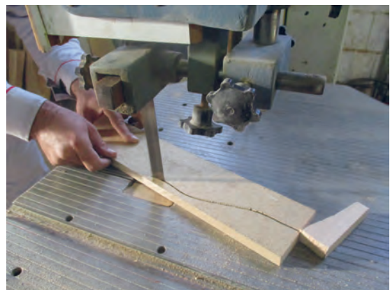
شکل ۶۲- عملیات قوس‌بری با دستگاه اره نواری
