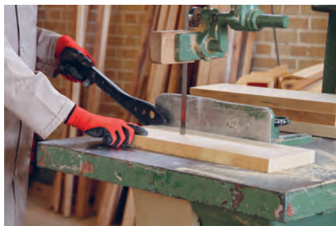
شکل ۴۰- وضعیت برش چوب قیدها
