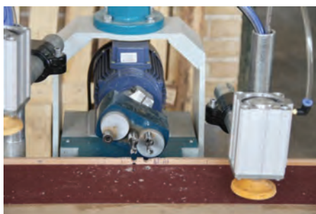
شکل ۳۸- ایجاد اتصال با دستگاه دوبل زن نیمه‌اتوماتیک
