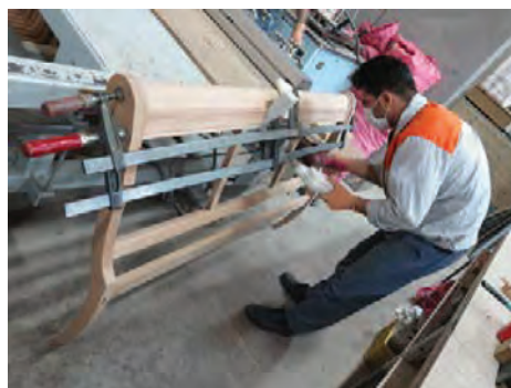
شکل ۵۲- تمیز کردن چسب اضافی روی قطعه کار
