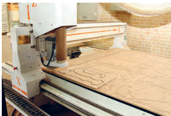
شکل ۶۷- تهیه شابلون با دستگاه فرز CNC
