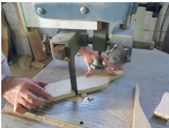
شکل ۶۲- عملیات قوس‌بری با دستگاه اره نواری
