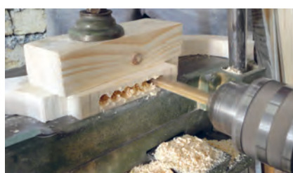
شکل ۸۸- عملیات کم کنی با دستگاه سه کاره
