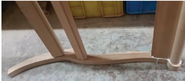
شکل ۴۸- جا زدن پشتی مبل
