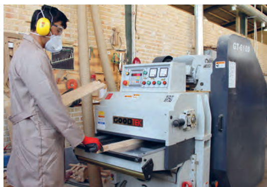
شکل ۷۸- نحوه گندگی کردن چوب‌های کم عرض
