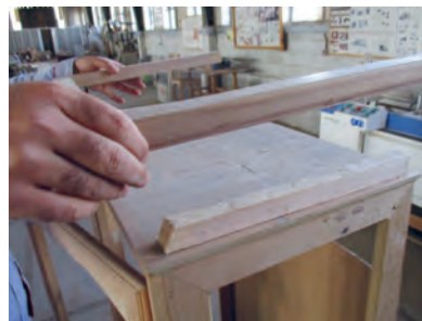
شکل ۸۱- نصب تاج به بدنه
