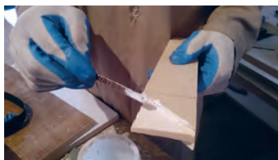
شکل ۲۳- چسب زدن اتصالات قاب
