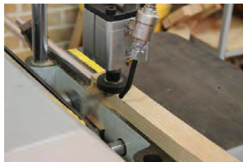
شکل ۴۰- اتصال کام با دستگاه کام کن نیمه‌اتوماتیک
