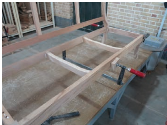
شکل ۵۶- جا زدن اتصالات با گیره دستی
