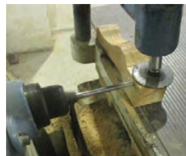
شکل ۶۵- عملیات اتصال دوبل با دستگاه کم‌کن
