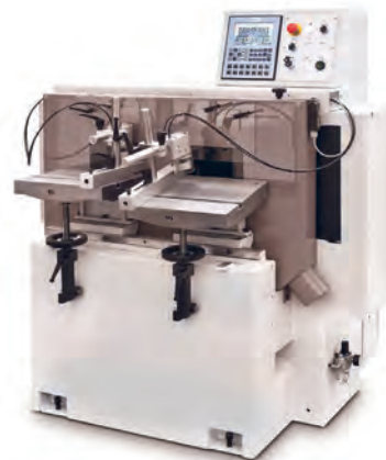
شکل ۵۸- دستگاه اتصال زن زبانه
