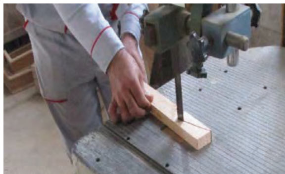
شکل ۶۳- پایان قوس‌بری با دستگاه اره نواری
