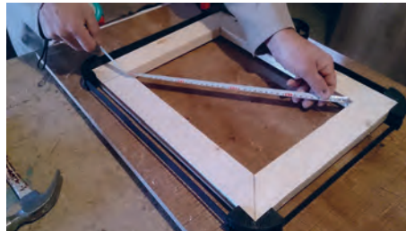
شکل ۲۵- کنترل دوئیدگی و صحیح بودن قاب
