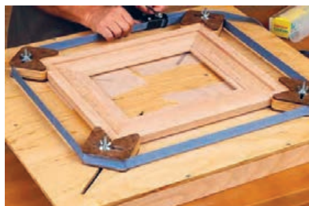
شکل ۷۲- گیره مخصوص بستن قاب
