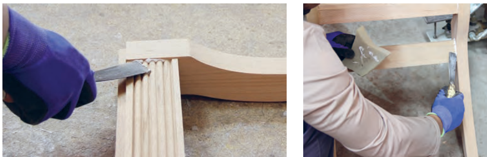
شکل ۶۷- تمیز کردن چسب اضافی با کاردک
