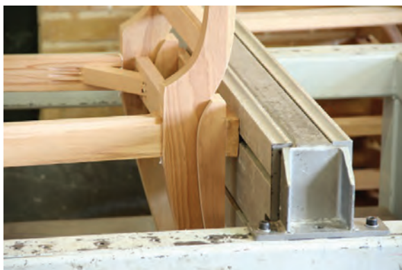
شکل ۵۵- جا زدن اتصالات با تنگ پنوماتیکی
