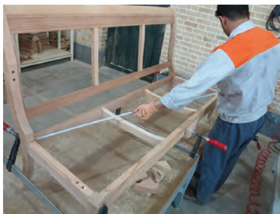
شکل ۵۷- کنترل دوئیدگی (گونمایی کردن کار) با متر
