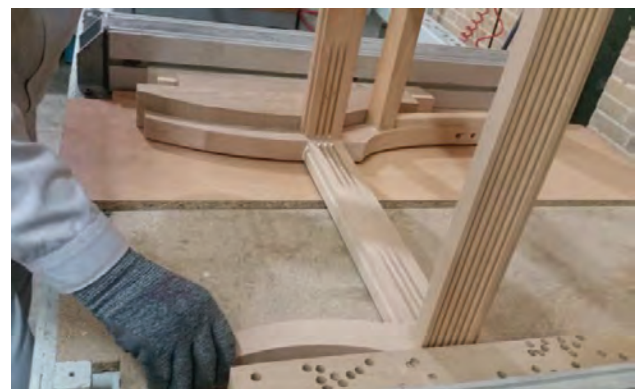
شکل ۵۵- جا زدن اتصالات با تنگ پنوماتیکی
