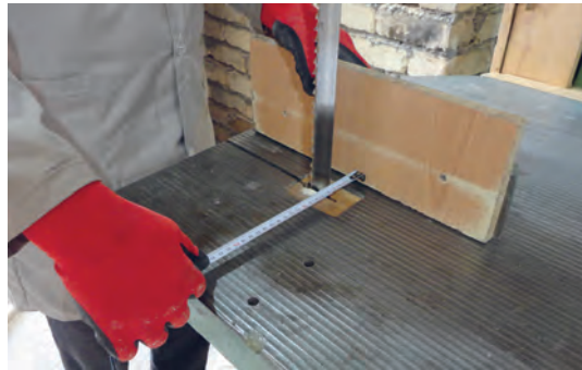
شکل ۷۴- اندازه‌گیری فاصله تیغه با گونیا
