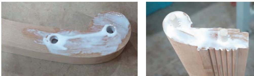
شکل ۴۶- روش چسب زدن اتصال دوبل پایه‌های عقب
