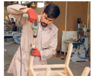
شکل ۱۱۲- سوراخکاری کف پایه با دریل
