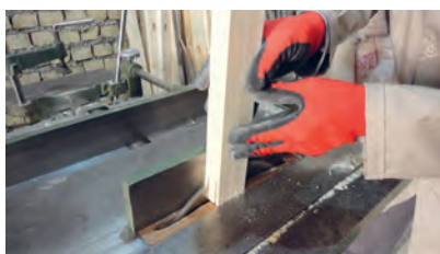
شکل ۹۱- عملیات برش زبانه با دستگاه اره گرد
