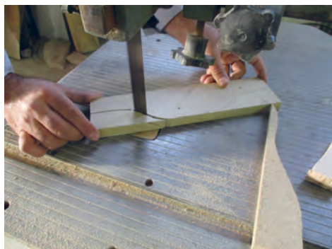
شکل ۶۳- پایان قوس‌بری با دستگاه اره نواری
