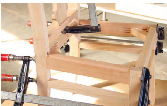
شکل ۱۱۰- نصب نبشی ها
