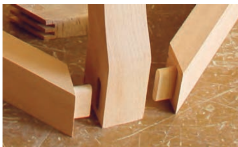
شکل ۱۰- اتصال و زبانه مخفی
