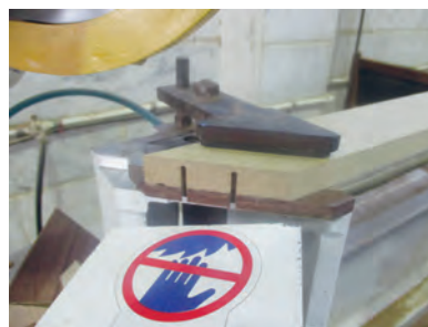
شکل ۶۹- دستگاه دم چلچله زن نیمه اتوماتیک
