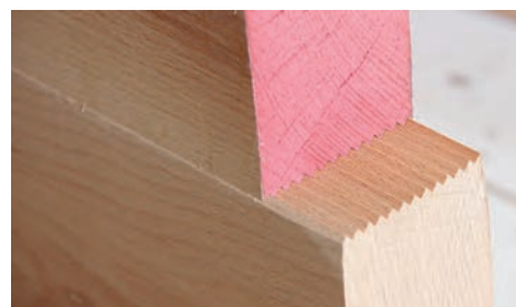
شکل ۱۳- اتصال انگشتی ساخته شده با دستگاه فرز
