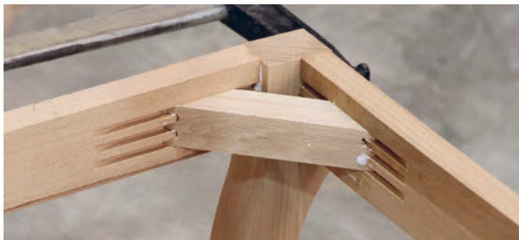
شکل ۱۲- اتصال انگشتی نبشی (بلوک سه‌گوش)
