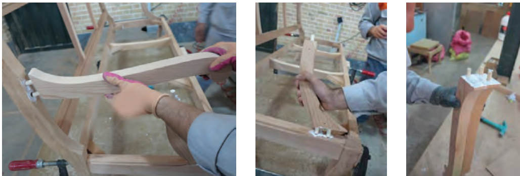
شکل ۶۰- جا زدن دسته مبل در محل اتصالات
