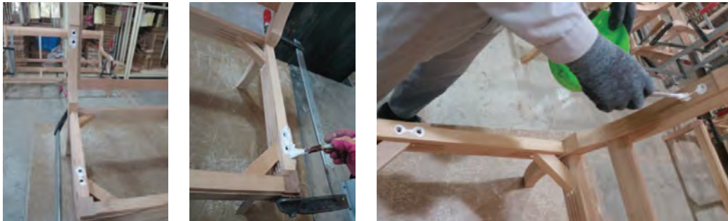
شکل ۵۹- چسب زدن محل اتصالات دسته مبل
