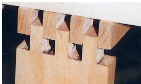
شکل ۱۲- اتصال انگشتی با تعداد زبانه فرد
