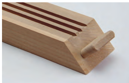
شکل ۹- اتصال زبانه زاویه دار
