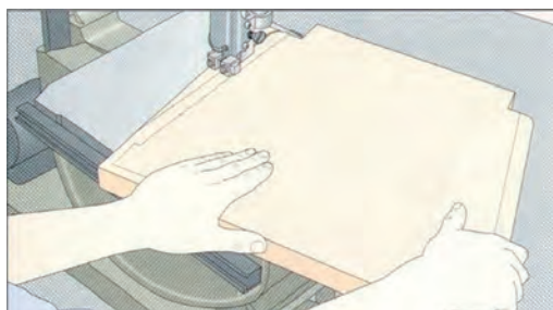
بریدن کفی توسط دستگاه اره نواری
