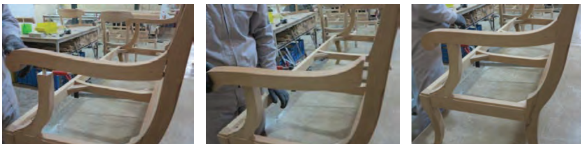
شکل ۶۱- کنترل صحیح بودن دسته مبل
