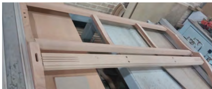
شکل ۵۰- جا زدن پشتی مبل با تنگ پنوماتیک
