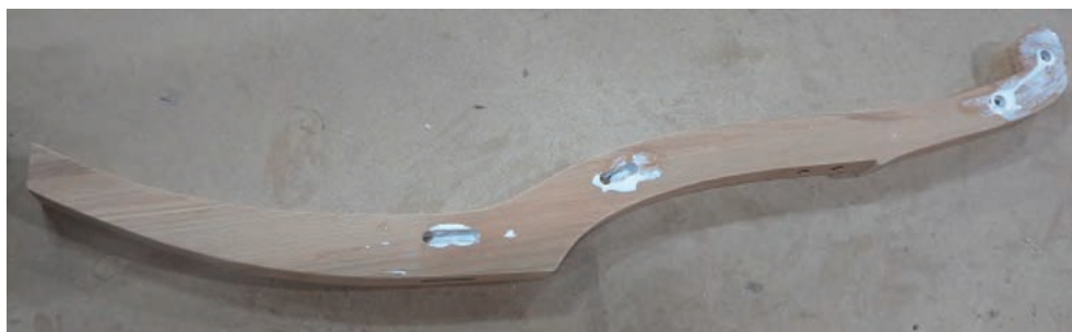
شکل ۴۶- روش چسب زدن اتصال دوبل پایه‌های عقب
