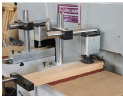
شکل ۴۲- ساخت زبانه با دستگاه زبانه‌زن نیمه اتوماتیک
