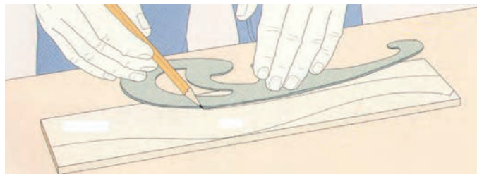
شکل ۴۲- آماده کردن الگوی پایه به وسیله پیستوله
