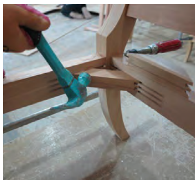
شکل ۵۸- جا زدن نبشی‌های گوشه
