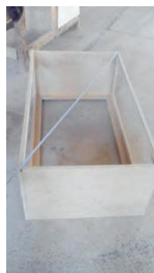
شکل ۷۸- کنترل دوئیدگی ویتترین قبل از پشت کوبی (شیار آینه قابل مشاهده است)
