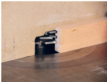
شکل ۶۱- تیغ فرز مخصوص زهوار صفحه
