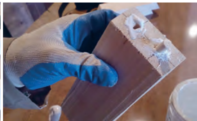
شکل ۳۵- چسب زدن اتصال دوپل
