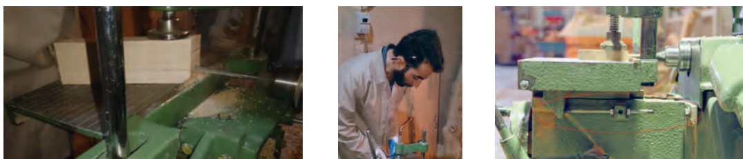
شکل ۳۲- عملیات سوراخ کاری اتصال دوبل
