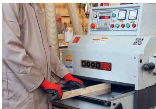
شکل ۷۸- نحوه گندگی کردن چوب‌های کم عرض
