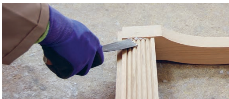
شکل ۱۰۲- تمیز کردن چسب اضافی با کاردک
