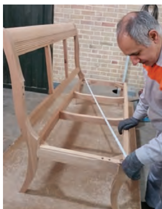
شکل ۵۷- کنترل دوئیدگی (گونمایی کردن کار) با متر
