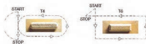
شکل ۸- انواع اتصالات مختلف کام و زبانه
