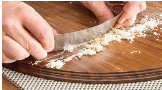
شکل ۱- استفاده از لیسه برای برداشتن مواد اضافی
