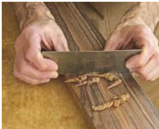
شکل ۵۵- لیسه کشی در جهت الیاف
