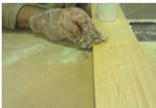
شکل ۶۶- زدن آب قبل از بتونه‌کاری
