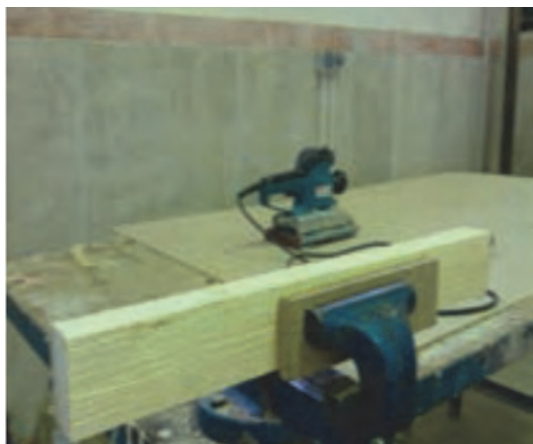
شکل ۴۵- بستن کار به گیره
