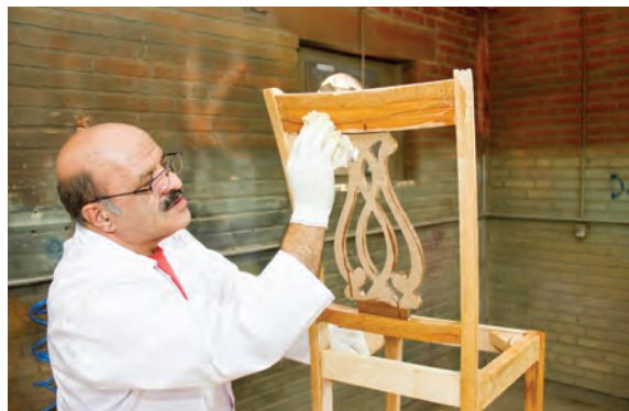
شکل ۱۴۶- زدن سیلر با کهنه رنگ‌کاری
