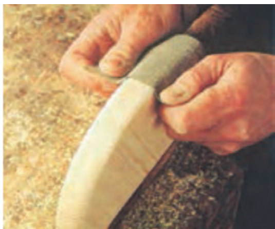
شکل ۱۵- سنباده کاری روی سطوح قوس دار
