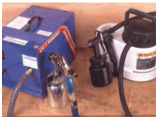
شکل ۱۸۳- دو نوع کمپرسور قابل حمل و سبک
