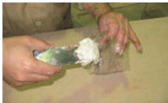
شکل ۶۸- قرار دادن بتونه سریش داخل پلاستیک
