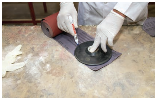
شکل ۲۹- ترسیم گردی دیسک روی سنباده
