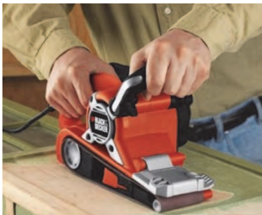
شکل ۵۳- روش کنترل و کاربرد صحیح دستگاه
