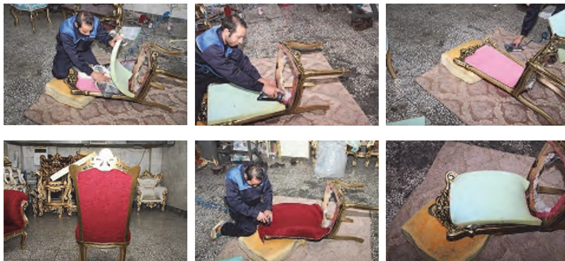
شکل ۳۷- مراحل رویه‌کوبی پشتی صندلی
