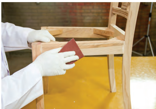
شکل ۱۱- نحوه سنباده کاری دستی
