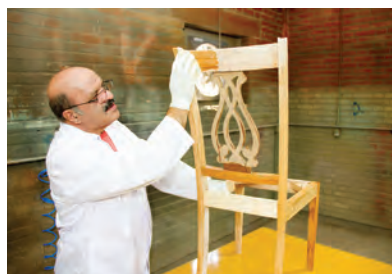
شکل ۵۹- زدن روغن بزرک با کهنه
