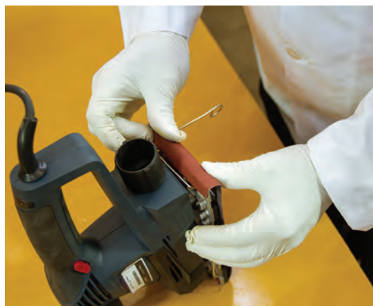
شکل ۴۴- روش جازدن سنباده
