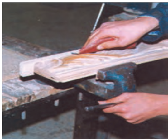
شکل ۱۶- نمدار کردن سطح چوب
