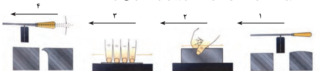
شکل ۱۱۷- مراحل تیزکردن لیسۀ
