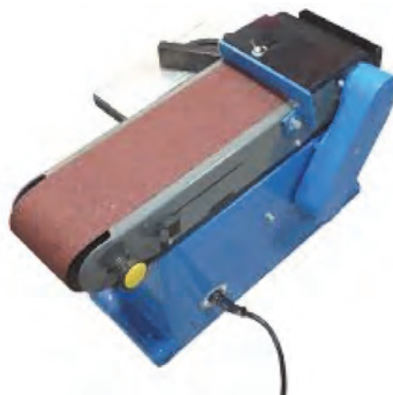
شکل ۵۲- با این پیچ می توان غلطک را حرکت داد
