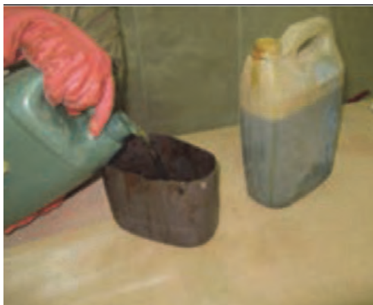
شکل ۴- رقیق کردن روغن الیف با تینر روغنی
