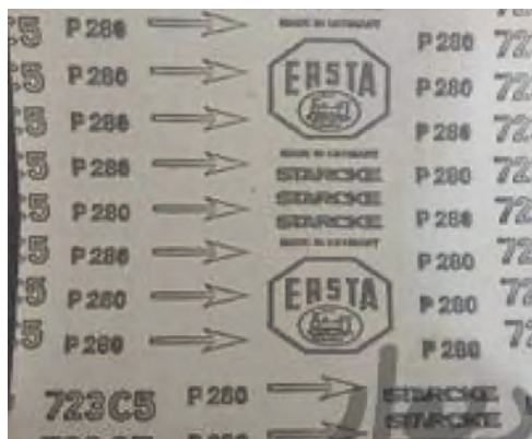
شکل ۵۱- به جهت فلش ورق سنباده توجه کنید.
