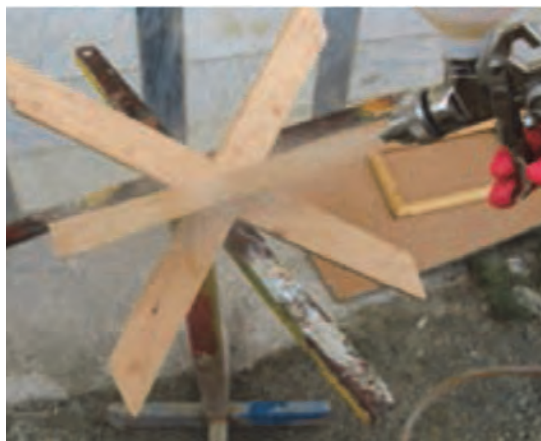
شکل ۴۰- زدن کیلر به کار با پیستوله
