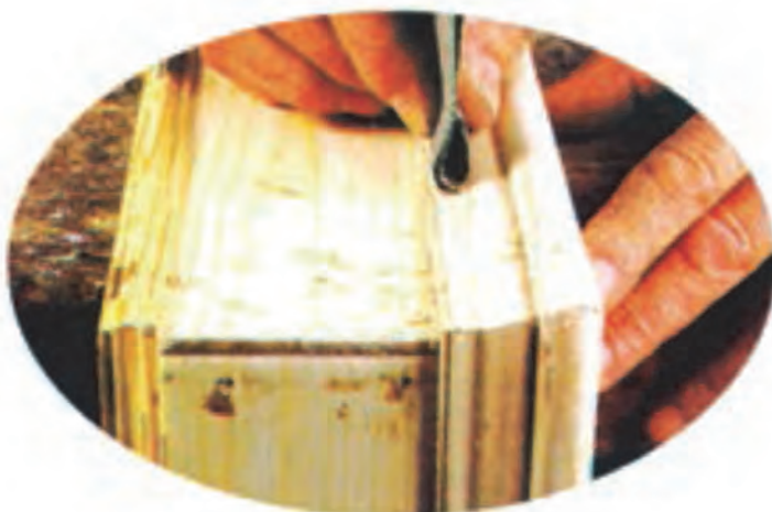
شکل ۱۴- سنباده کاری روی سطوح محدب و مقعر
