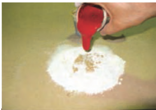
شکل ۷۹- اضافه نمودن روغن الیف به بتونه روغنی
