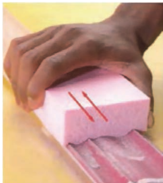
شکل ۱۰۸- تخته سنباده برای قطعه افزار خورده
