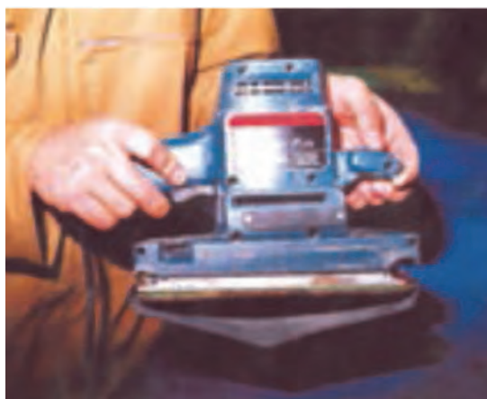
شکل ۴۷- شل شدن کاغذ سنباده
