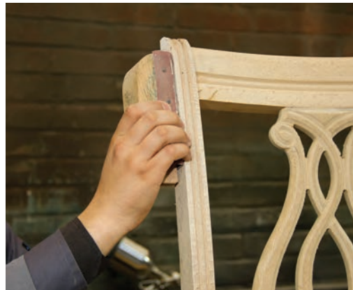
شکل ۹- سنباده کاری به کمک تخته پوست
