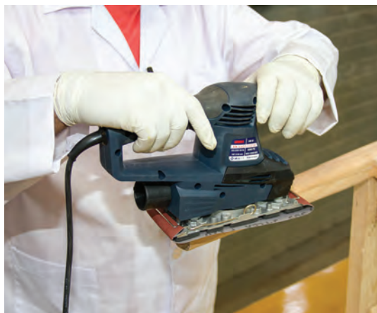
شکل ۴۶- سنباده کاری در جهت الیاف
