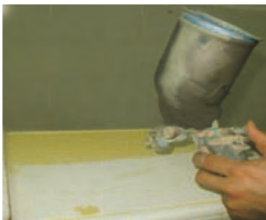
شکل ۲۹- پاشیدن رنگ نیترو سلولزی با پیستوله
