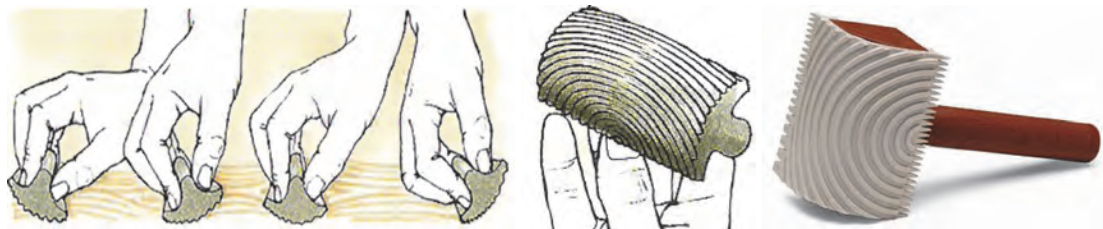
شکل ۱۶۰- روش صحیح استفاده از نقش‌انداز
