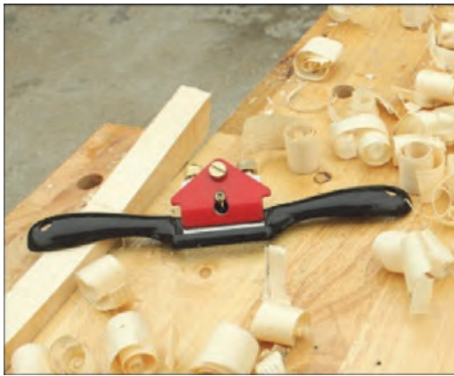
شکل ۵۸- نصب لیسسه به رنده بال کبوتری
