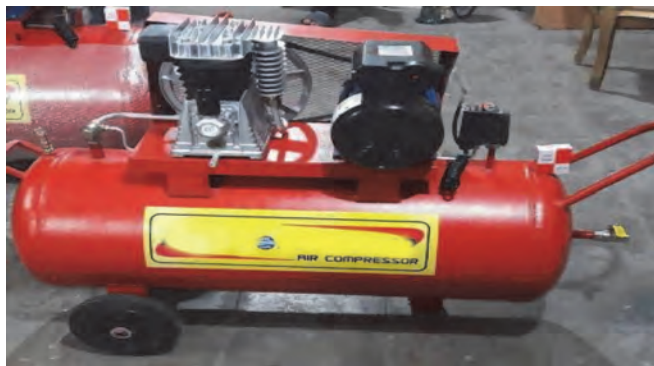
شکل ۱۹۰- هیچ گاه کمپرسور را به پهلو نخواستارید
