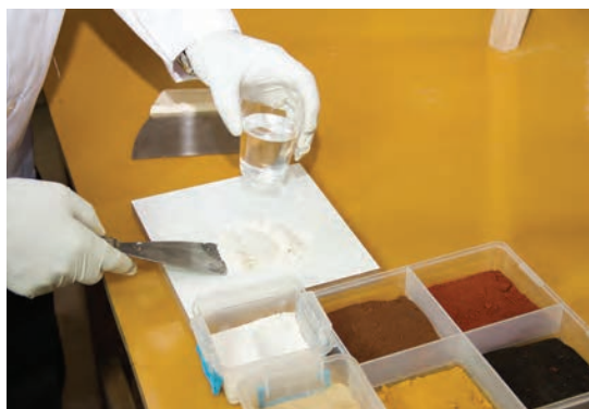
شکل ۷۰- اضافه کردن آب به بتونه
