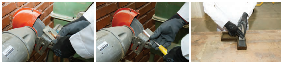
شکل ۳- تیز کردن تیغه رنده به صورت اصولی
