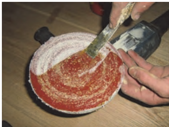
شکل ۱۷۷- چسباندن کاغذ سنباده به سنباده دیسکی
