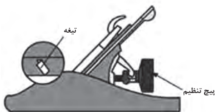
شکل ۶- پیچ تنظیم رنده
