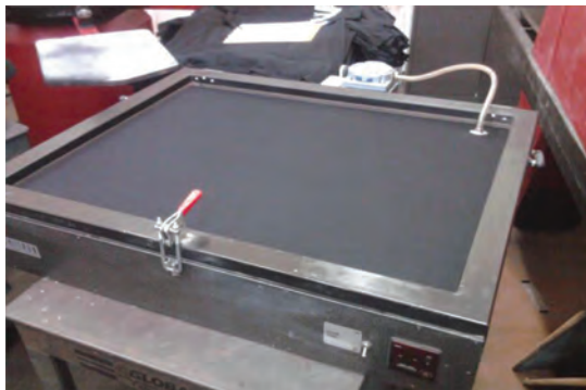
شکل ۱۳- میز نور با مکانیزم مکش هوا
