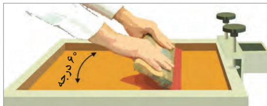
شکل ۱۶- نحوه کشیدن راکل به روش دستی
