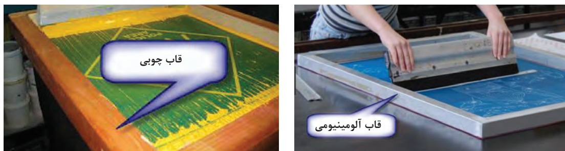
شکل ۵- نمونه‌ای از قاب آلومینیومی و قاب چوبی
