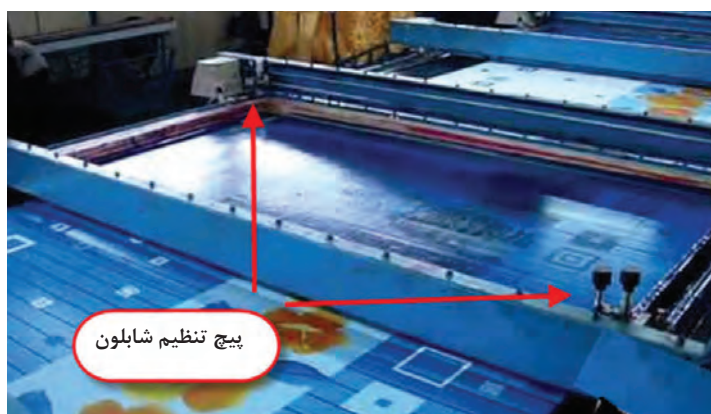
شکل ۱۰- پیچ‌های تنظیم شابلون
