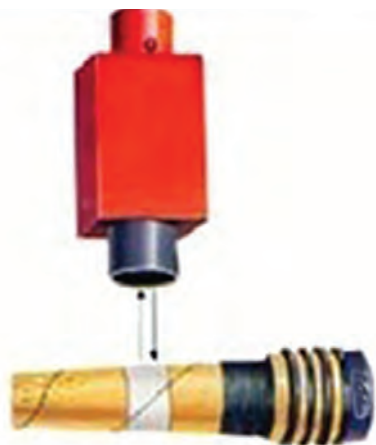
شکل ۸- مکانیزم فتوالکتريکی حس کننده ماسوره خالی
