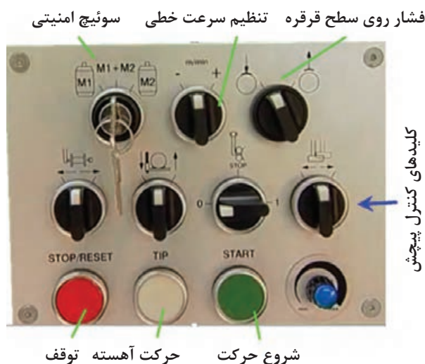
شکل ۱۲ - کلیدهای راه‌اندازی یک دستگاه پیچش قرقره
