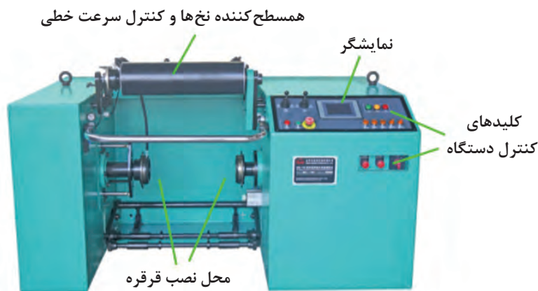
شکل ۱۱ - دستگاه پیچش قرقره
