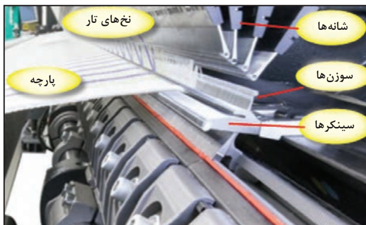
شکل ۲۹- منطقه بافت در یک ماشین واقعی
