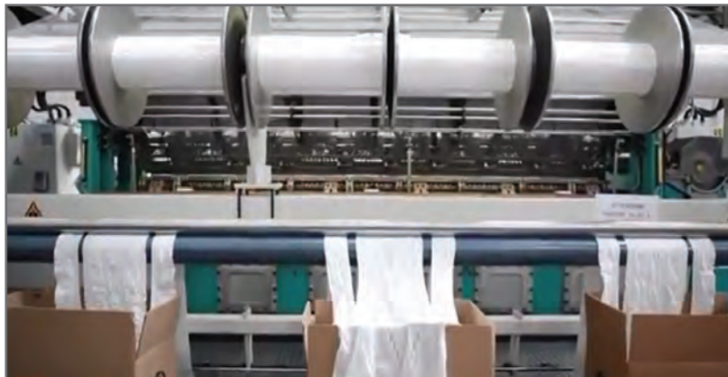
شکل ۱۷ - ماشین‌های بافندگی تار لباس بافی بدون درز
