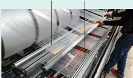
شکل ۲۳ - قرار دادن لایه نخ‌های تار قرقه روی شاسی ماشین گره‌زن
