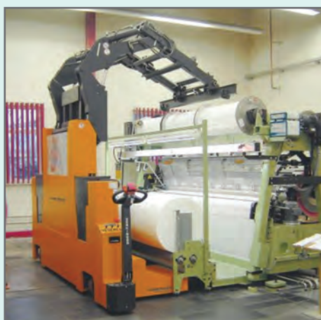
شکل ۱۹ - نحوه انتقال نورد حاوی قرقه‌ها روی ماشین
