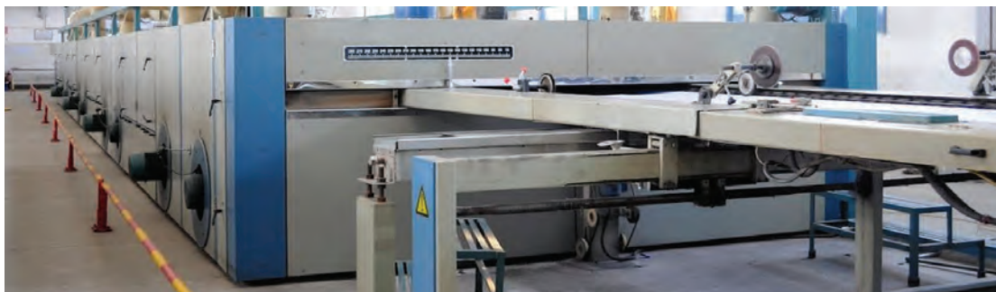
شکل ۱۷- تصویر یک عدد ماشین استنتر
