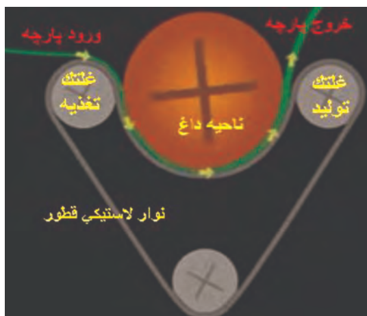
شکل ۴- قسمت تغذیه در ماشین کامپکتور
