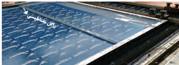
شکل ۱۲- راکل میله‌ای آهن ربایی (مغناطیسی)
