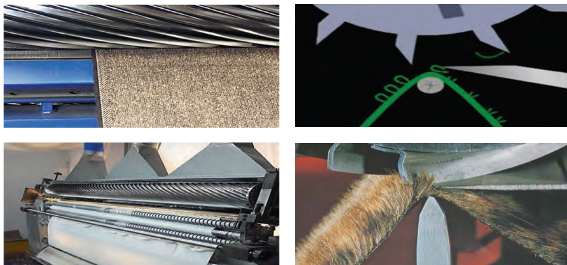
شکل ۱۰- تصویر تیغه مارپیچی و ماشین تراش پارچه
