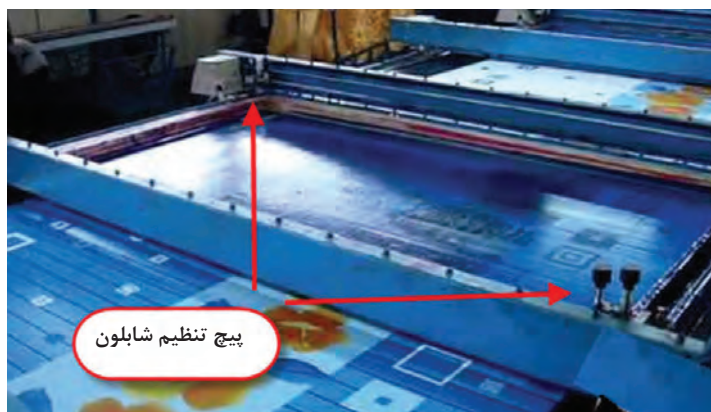
شکل ۱۰- پیچ‌های تنظیم شابلون
