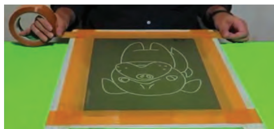
شکل ۱۴- نحوه چسب زدن پشت توری
