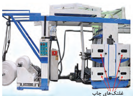
شکل ۱۴- نمای یک ماشین چاپ غلتکی
