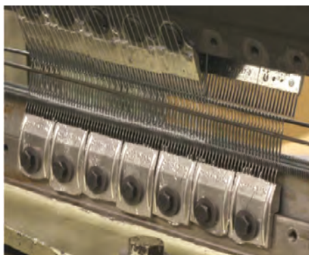
شکل ۳۱ - نصب بلوک سوزن‌ها با پیچ روی صفحه
