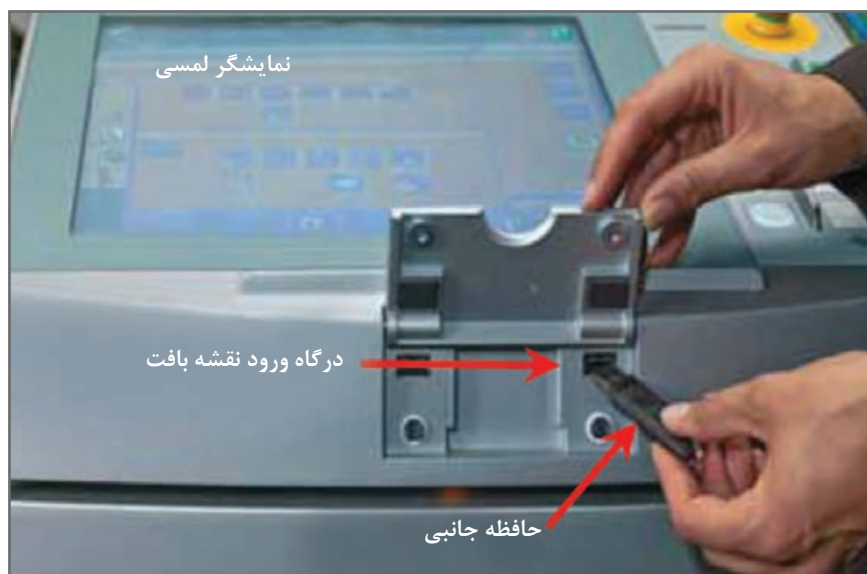
شکل ۳۵- نحوه اتصال حافظه جانبی به ماشین بافندگی
