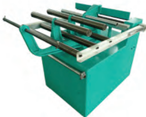
شکل ۹ - دستگاه ذخیره دسته نخ تار
