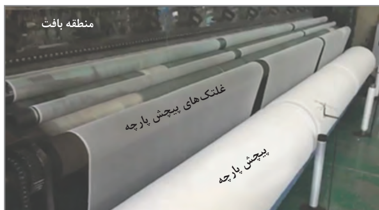
شکل ۵۲ - غلتک‌های کشش و پیچش پارچه
