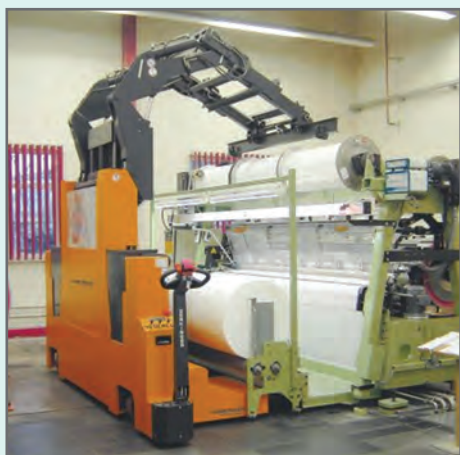
شکل ۱۹ - نحوه انتقال نورد حاوی قرقه‌ها روی ماشین
