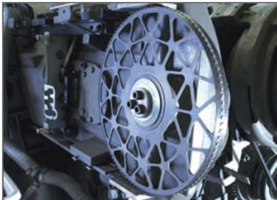
شکل ۱۹- غلتک دوران کننده و محرک راپیر
