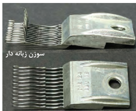
شکل ۳۱ - نصب بلوک سوزن‌ها با پیچ روی صفحه
