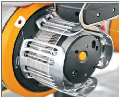
شکل ۲۸- یک مکانیزم ذخیره نخ پود استوانه‌ای
