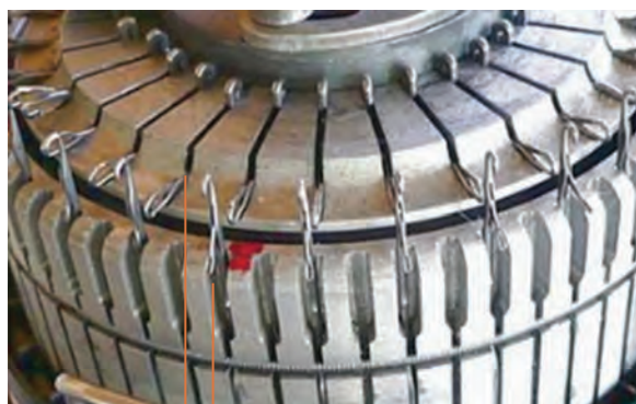
سوزن‌های روی صفحه سوزن‌های روی سیلندر
