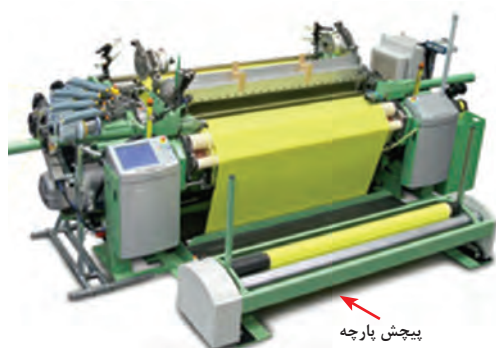
شکل ۱۷- باز شدن نخ تار و پیش پارچه در ماشین های بافندگی
