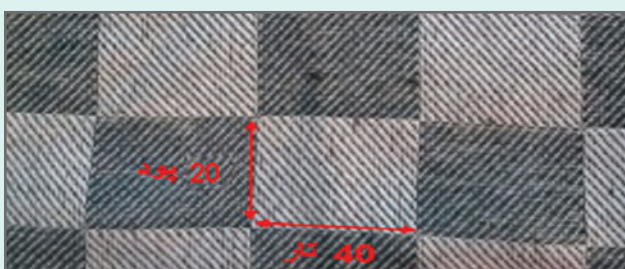
شکل ۱۹- پارچه با طرح بافت مشتقات سرژه
