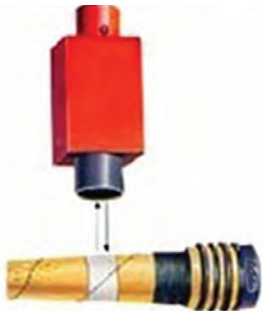
شکل ۸- مکانیزم فتوالکتریکی حس کننده ماسوره خالی
