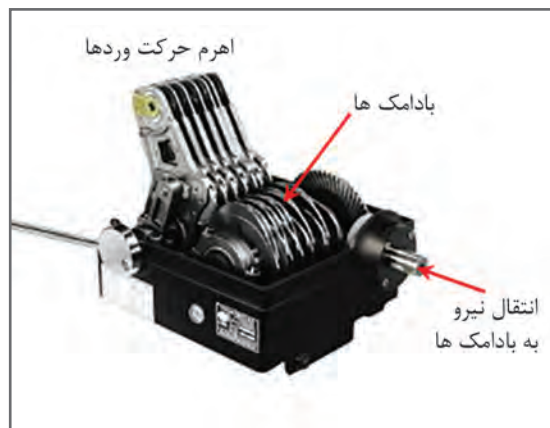
شکل ۱۱- مکانیزم بادامک خارجی
