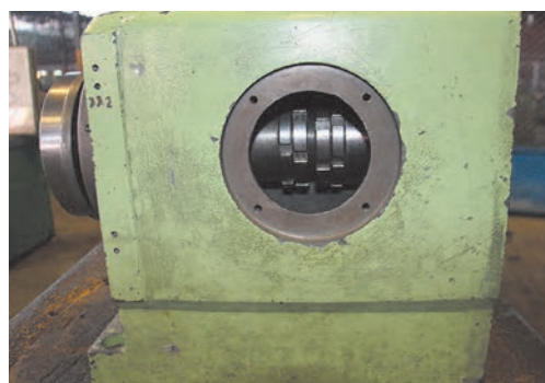
شکل ۵- سفت کردن یاتاقان جلوی دستگاه
