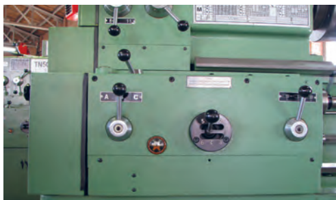
شکل ۲۵- موقعیت جعبه دنده پیچ‌بری
