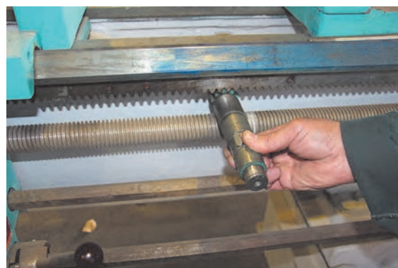
شکل ۱۵- درگیری چرخ دنده با دنده شانهای
