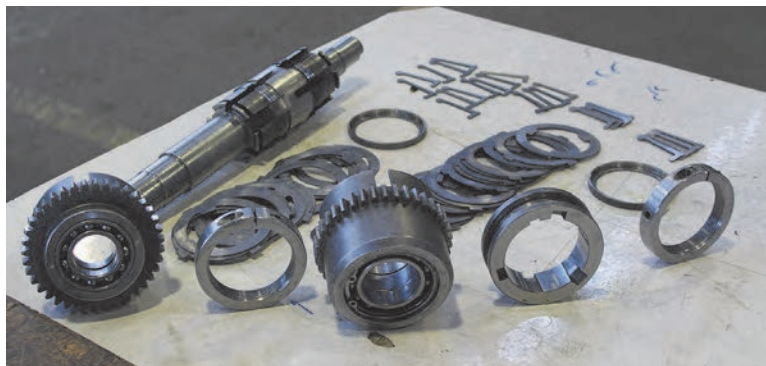
شکل ۴۰- اجزای مجموعه کلاچ
