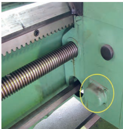
شکل ۲۰- پیچ تنظیم حساسیت اهرم‌های خودکار
