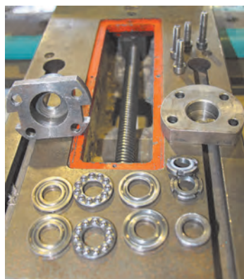
شکل ۹- یاتاقان‌بندی پیچ هادی محور عرضی
