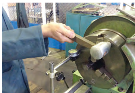
شکل ۷- اندازه‌گیری میزان لقی محوری
