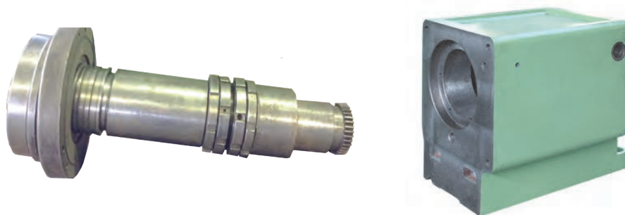
شکل ۱- پوسته و محور اصلی دستگاه تراش
