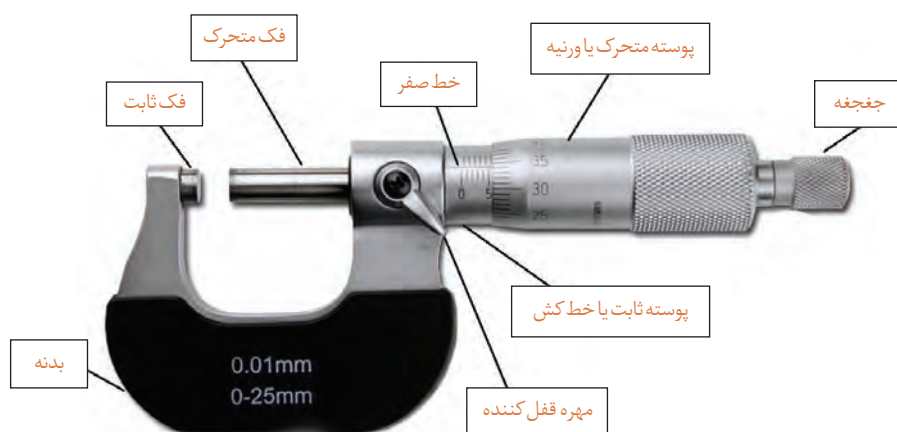
شکل ۱- میکرومتر خارجی
