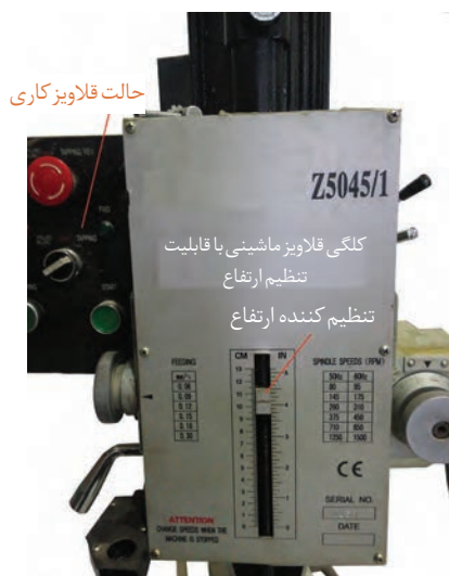
شکل ۴- کُلگی قلاویز ماشینی با قابلیت تنظیم ارتفاع
