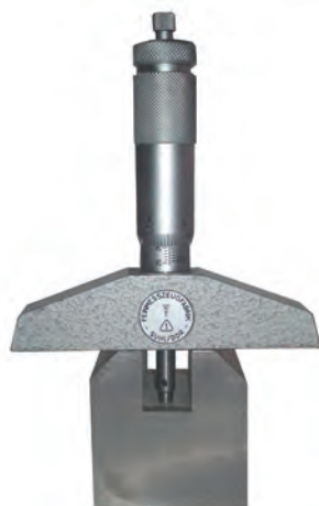
شکل ۵- اندازه‌گیری با میکرومتر عمق سنج
