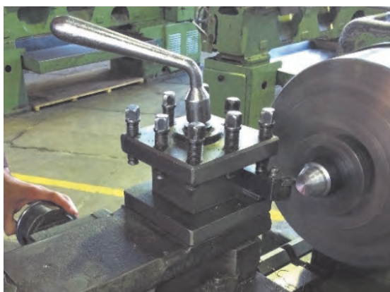
شکل ۱۰- حرکت همزمان سوپرت‌های دستگاه
