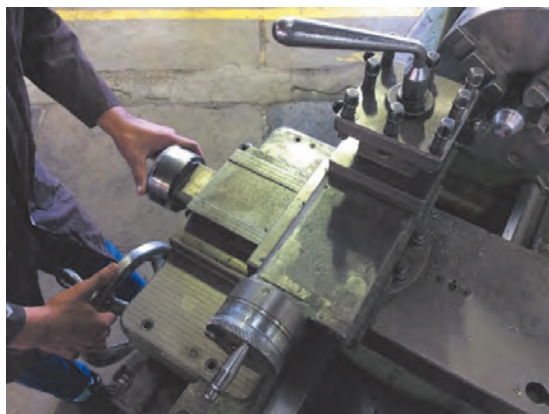
شکل ۱۰- حرکت همزمان سوپرت‌های دستگاه
