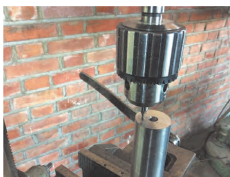
شکل ۲۳ - مته‌مرغک‌زنی به وسیله ماشین مته ستونی
