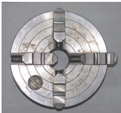
شکل ۱۸- سه‌نظام و چهارنظام تک‌رو
