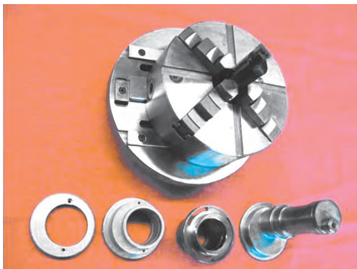
شکل ۱۷- سه‌نظام قابل تنظیم و قطعات تولید شده
