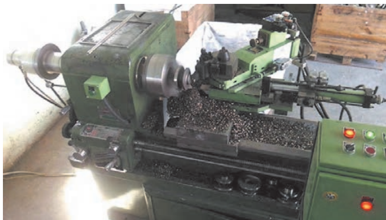
شکل ۷- عملیات کپی تراشی
