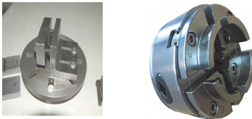
شکل ۱۹ - فیکسچرهای مخصوص لنگ تراشی
