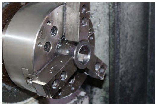
شکل ۹- استقرار سه‌نظام روی مجموعه محور اصلی
