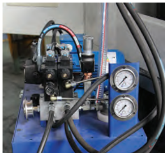
شکل ۱۱- سیستم هیدرولیک ماشین تراش CNC مدل ۴۰ TME
