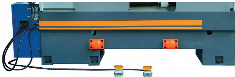
شکل ۵- مجموعه پایه و بدنه دستگاه تراش
