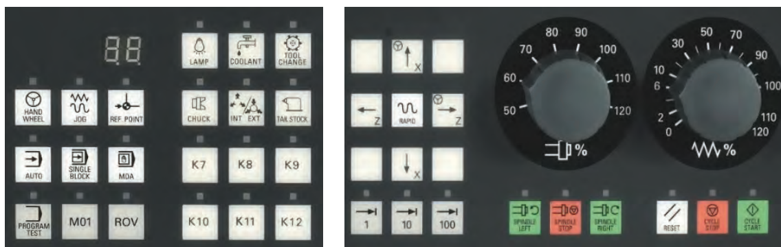
شکل ۱۷- کلیدهای اپراتوری سیستم کنترل
