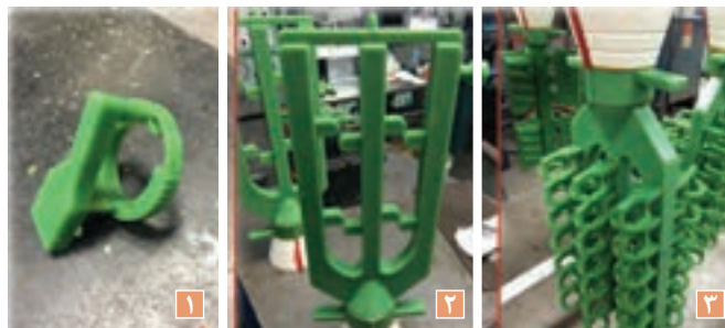
شکل ۱۹- شماره ۱: مدل مومی با راهباره به تنهایی شماره ۲: راهگاهی به تنهایی شماره ۳: مدل خوشه‌ای
