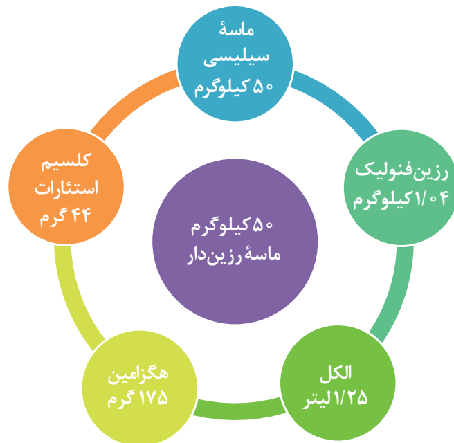
شکل ۵- مقادیر و مواد لازم برای تهیه ۵۰ کیلوگرم ماسه رزین دار به روش پوشش هوای گرم
