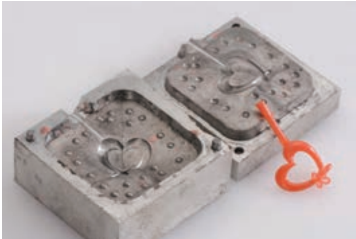
شکل ۱۴- نمونه‌ای از یک قالب فلزی جهت تولید مدل مومی
