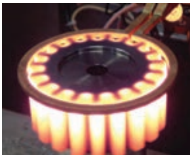
شکل ۳۳- سخت کردن چرخ دنده به روش القا
