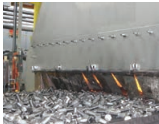
شکل ۶- کوره عملیات حرارتی مداوم
