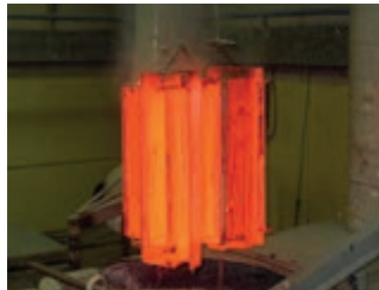
شکل ۳۰- کربوره کردن مایع در حمام نمک
