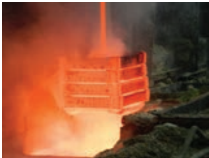
شکل ۳۰- کربوره کردن مایع در حمام نمک
