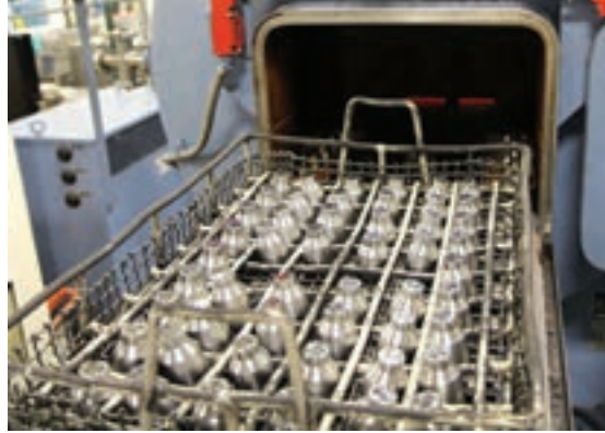
شکل ۱۶- قرارگیری سبد حاوی قطعات جلوی در کوره
