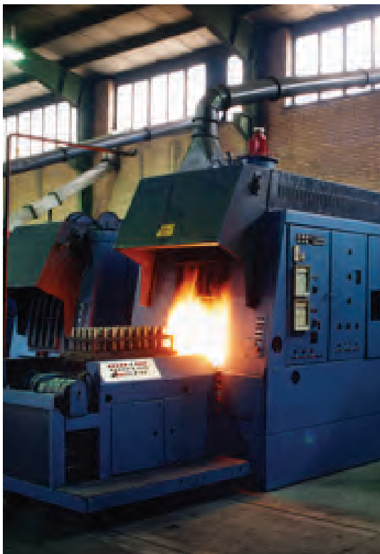
شکل ۳۱- کوره کربورایزینگ گازی
