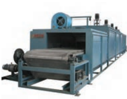
شکل ۶- کوره عملیات حرارتی مداوم
