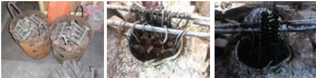
شکل ۲۶- تمپر کردن قطعات
