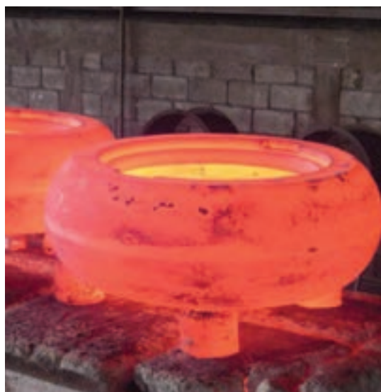
شکل ۹- خارج کردن قطعات از کوره و سرد شدن در هوای ساکن
