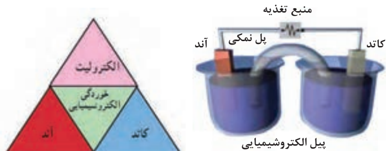
شکل ۳- اجزای اصلی پیل الکتروشیمیایی خوردگی
