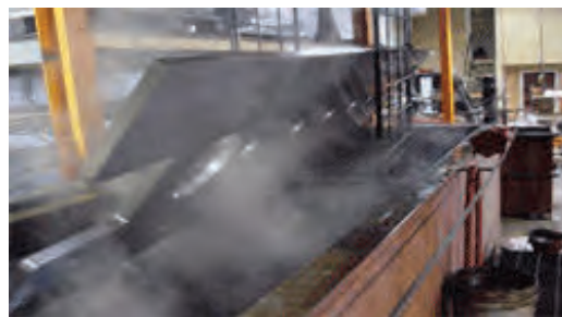
شکل ۲۰- عملیات سیاه کاری
