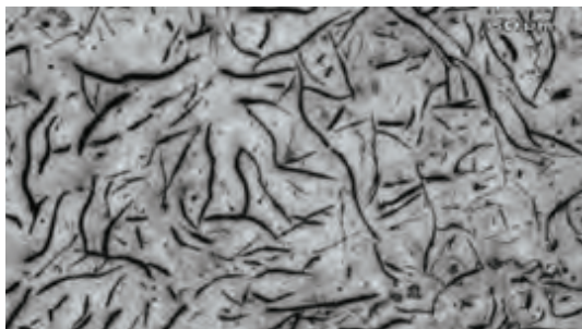
شکل ۳۴- ساختار میکروسکوپی چدن هیپریوتکتیک (کیش گرافیت و گرافیت ریز در زمینه فریت)
