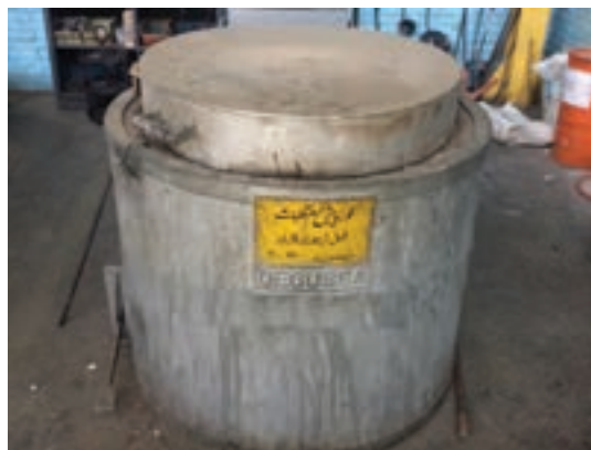
شکل ۱۹- کوره پیش گرم قطعات
