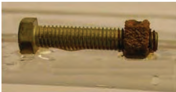
شکل ۶- خوردگی گالوانیکی در اثر اتصال دو فلز متفاوت کنار هم
