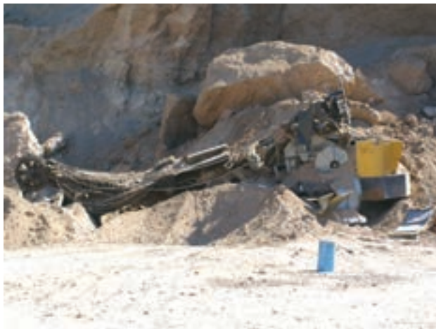
ریزش کمر بالا بر روی ماشین آلات در اثر ایجاد زیر برش
