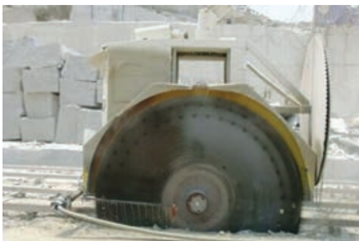
دستگاه دیسک برنده در حال برش سنگ
