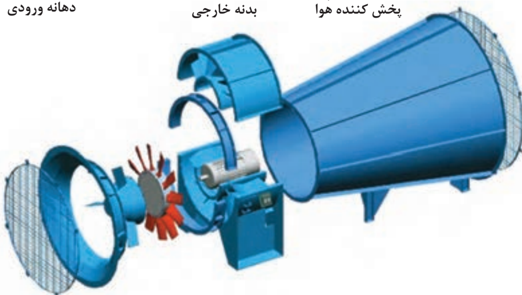
ساختمان فن های محوری
