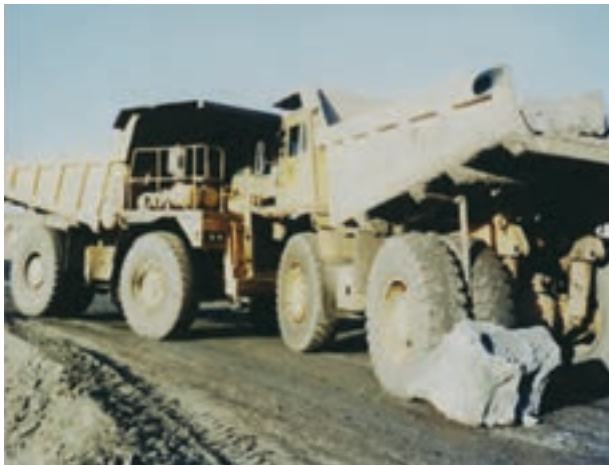
تصادف دامپ تراک‌ها در اثر عرض کم مسیر تردد
