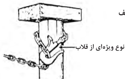
الف) نحوه بستن قلاب به دور پایه
