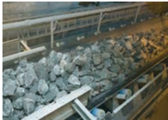
حمل مواد معدنی فلزی زیر زمینی از طریق نوار نقاله و واگن
