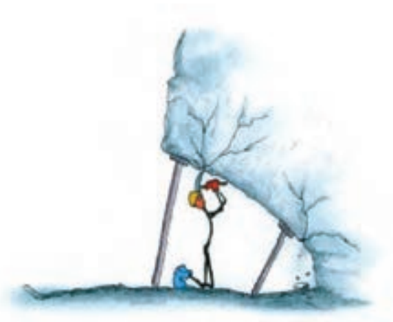
ایجاد زیر برش با نصب وسیله نگهدارنده
