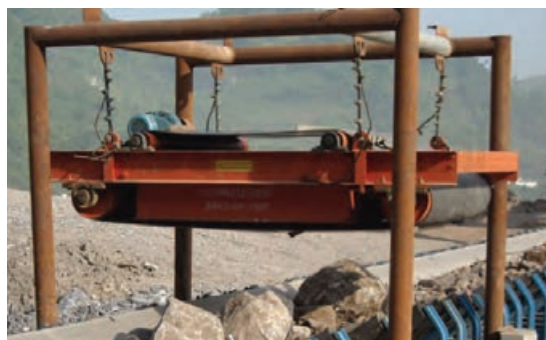
شکل ۲۶- جدا کننده های مغناطیسی معلق نوار متقاطع
