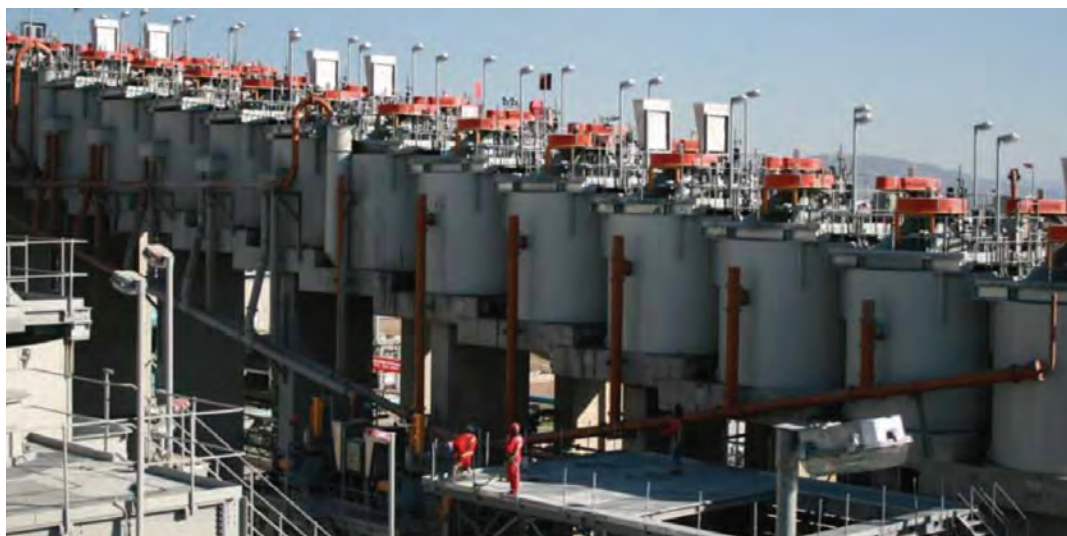
شکل ۵- تصویر واقعی از یک بانک فلوتاسیون
