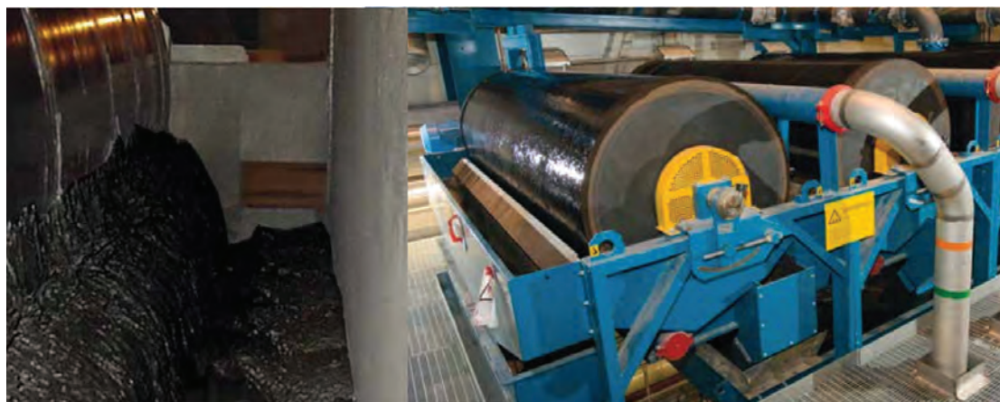
شکل ۳۰- جدا کننده های مغناطیسی استوانه ای تر
