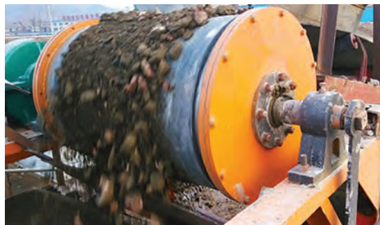
شکل ۲۴- غلتک مغناطیسی
