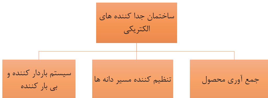
شکل ۳۷ - ساختمان جداکننده‌های الکتریکی
