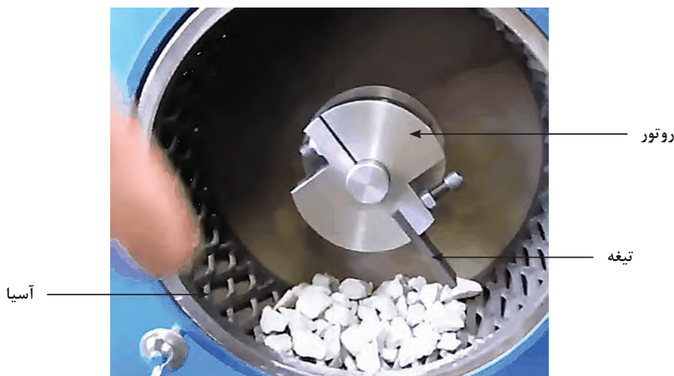
شکل ۳- نمای داخلی آسیای استاندارد ساینده‌گی باند
