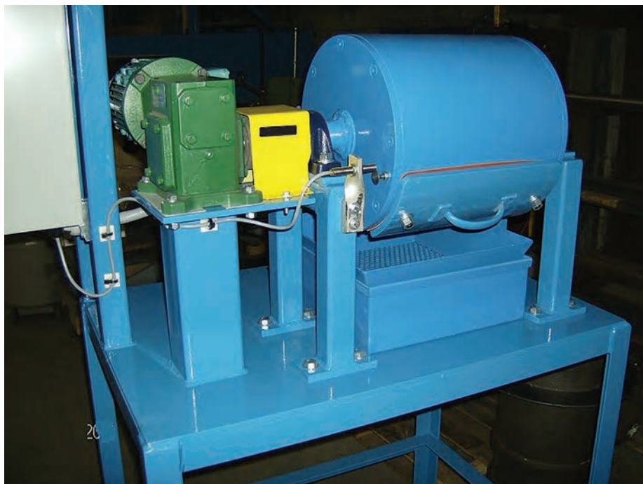
شکل ۲- آسیای گلوله ای آزمایشگاهی باند
