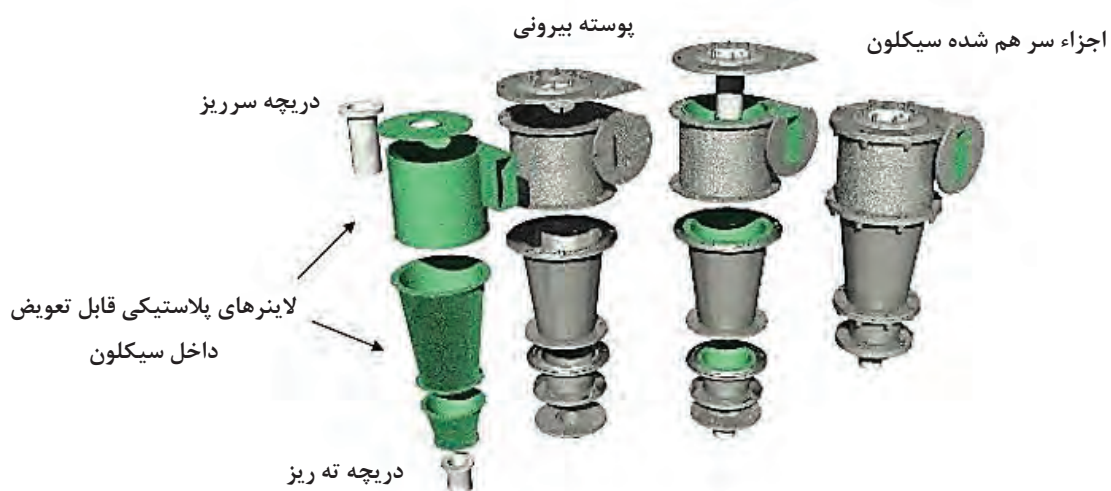
شکل ۲۱- اجزاء تشکیل دهنده سیکلون
