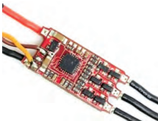
کنترل کننده سرعت (ESC)
