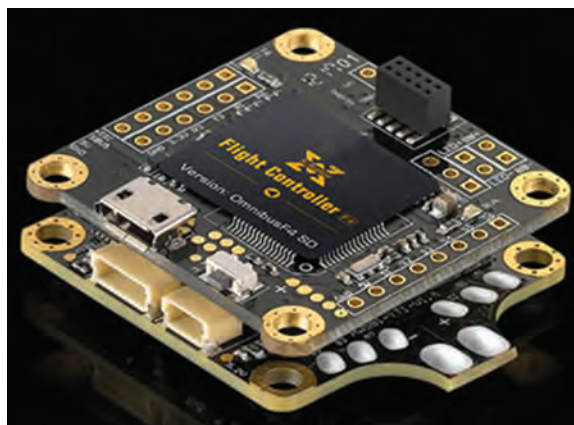
کنترل کننده پرواز (Flight Controller)
