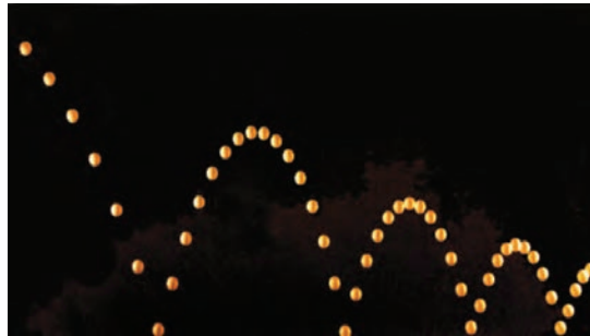
شکل ۵- نمودار استروبوکس یک توپ گلف که از سطح سفت وا می‌جهد. میان ضربه‌ها، توپ حرکت پرتابی دارد.
