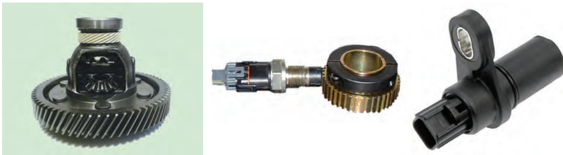
شکل ۵۸- حسگر و چرخ‌دنده بسته شده روی دیفرانسیل
