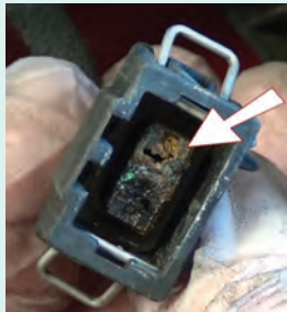
شکل ۶۲- یک نمونه سوکت معیوب
