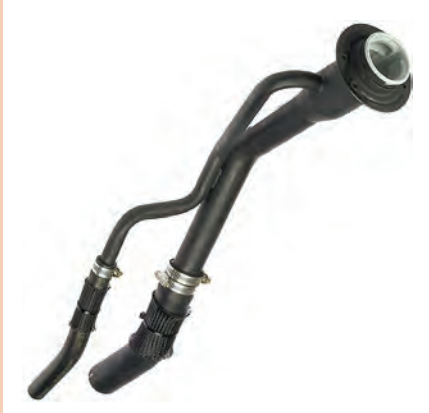
شکل ۳۷- لوله فلزی ورودی و مجرای کناری
