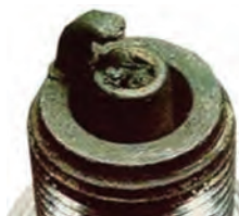
شکل ۳- آسیب به شمع بر اثر خودسوزی
