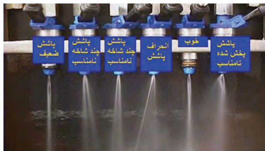
شکل ۷۷- انواع احتمالی پاشش سوخت در انژکتور
