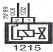
شکل ۵- نماد سوپاپ برقی کنیستر در نقشه‌ها
