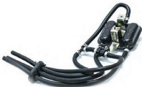
شکل ۶- ساختمان سیستم حباب‌گیر بنزین
