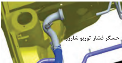
شکل ۳۲- موقعیت حسگر فشار توربو شارژر
