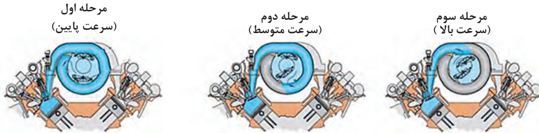
شکل ۴۲- عملکرد سیستم TUMBLE
