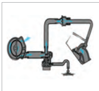
پمپ تزریق ثانویه اسماگ
