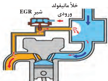
شکل ۱۹- مسیر عبور گازهای خروجی خلأی
