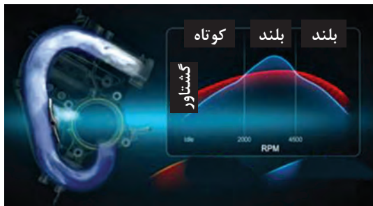
شکل ۳۸- وضعیت مسیر عبور هوا در دور بالا و پایین
