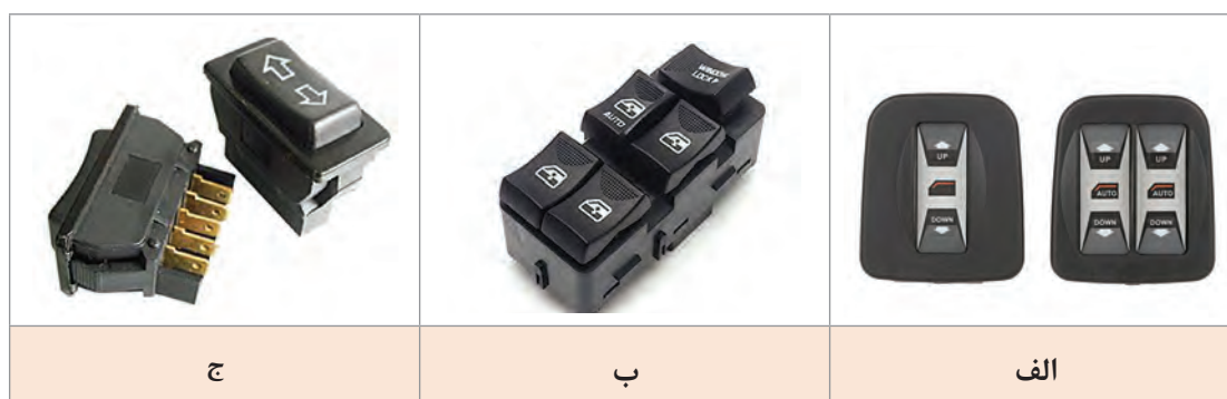
شکل ۵- چند نمونه کلید شیشه بالابر
