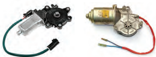
شکل ۴- دو نوع موتور شیشه بالابر
