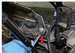
۵- پوشش پلاستیکی روی بازوی برف پاک‌کن را برداشته و با آچار مناسب مهره آن را باز کنید.
