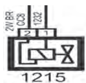
شکل ۵- نماد سوپاپ برقی کنیستر در نقشه‌ها
