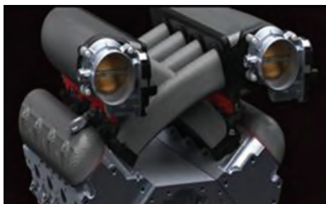
شکل ۳۷- دو نمونه مانیفولد متغیر هوای ورودی
