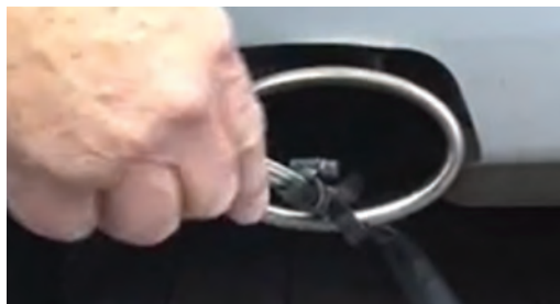
شکل ۸۱- روش صحیح نصب حسگر دستگاه تست گاز در اگزوز خودرو
