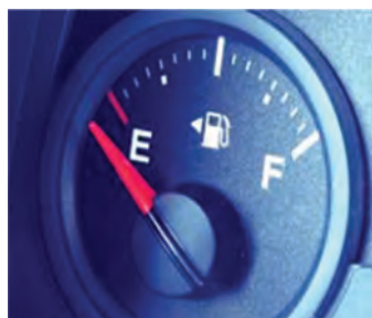
شکل ۱۷- نمایشگر سوخت آنالوگ (عقربه‌ای)
