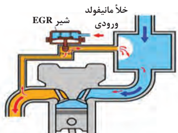
شکل ۱۹- مسیر عبور گازهای خروجی خلأی
