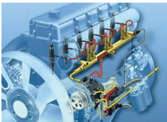
شکل ۶۴- اجزای سیستم سوخت‌رسانی ریل مشترک
