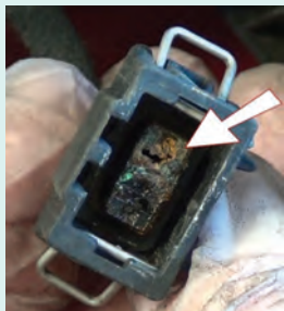
شکل ۶۲- یک نمونه سوکت معیوب
