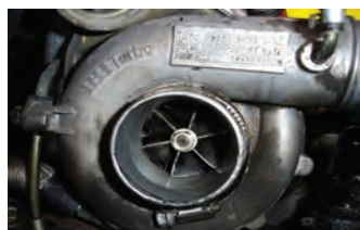
شکل ۸۳- نشست روغن در توربوشارژر
