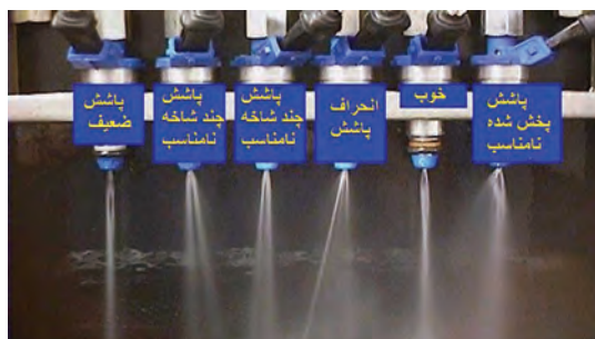
شکل ۷۷- انواع احتمالی پاشش سوخت در انژکتور
