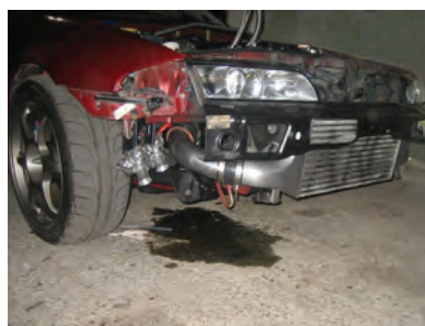
شکل ۴۹- یک نوع نشتی سیستم سوخت‌رسانی
