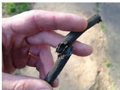
شکل ۴۹- یک نوع نشتی سیستم سوخت‌رسانی
