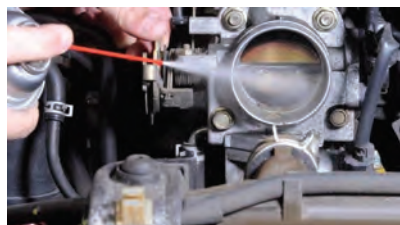
شکل ۸۱- سرویس دریچه گاز
