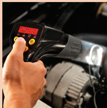
شکل ۲۱- روش کاربری چراغ تایمینگ
