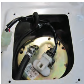
اتصال با پیچ و واشر لاستیکی
