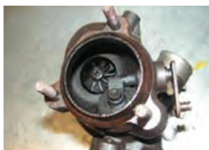
شکل ۸۳- نشست روغن در توربوشارژر
