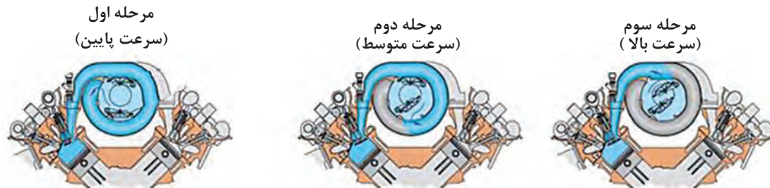
شکل ۴۲- عملکرد سیستم TUMBLE
