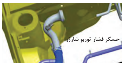
شکل ۳۲- موقعیت حسگر فشار توربو شارژر
