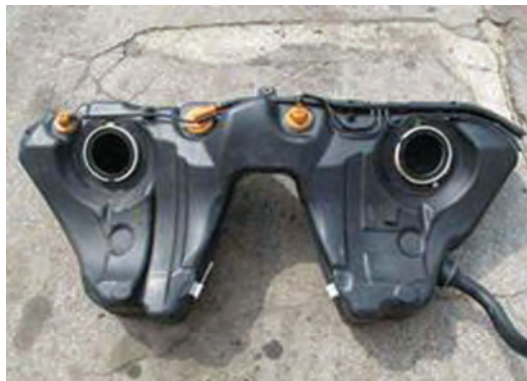
شکل ۷- مخزن سوخت با سوپاپ واژگونی
