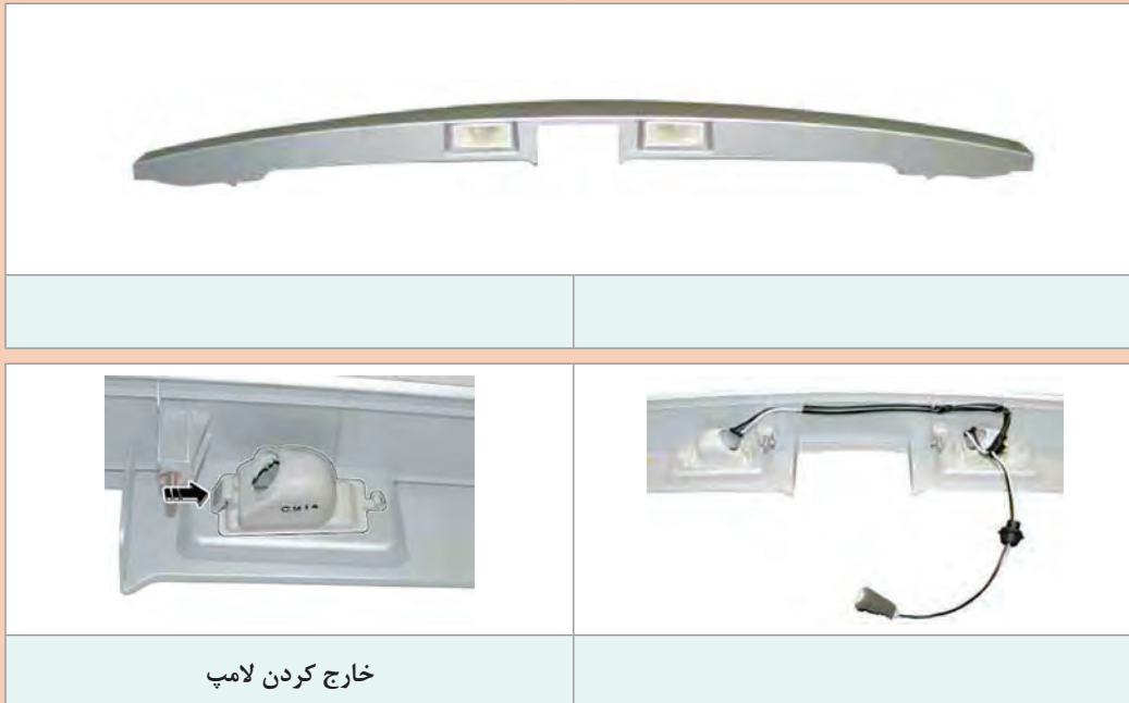
شکل ۳۵- روش باز کردن و بستن چراغ پلاک
