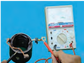
- آزمایش اتصال بدنه بالشتک ها
