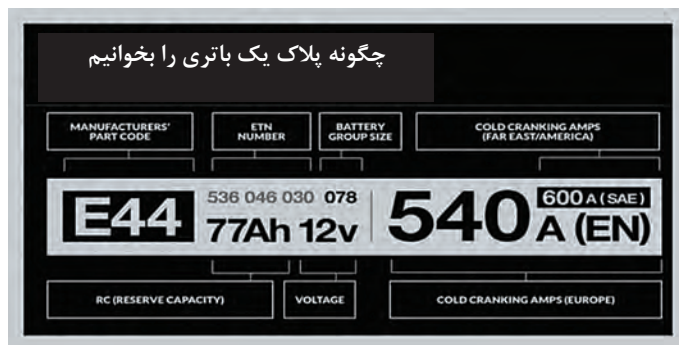
شکل ۴۴- دو نوع پلاک باتری و روش خواندن آن
