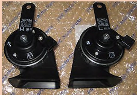
شکل ۴۸- درج L و H روی دستگاه بوق
