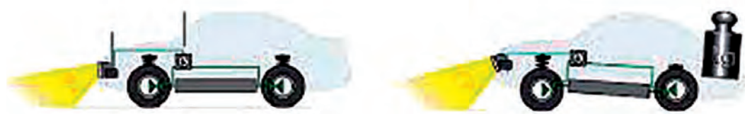
شکل ۹- دلیل نیاز به سیستم تنظیم ارتفاع چراغ
