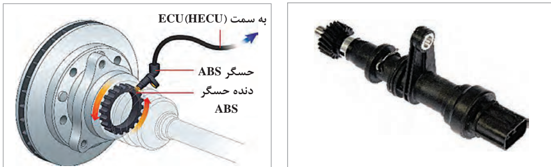
شکل ۱۶- حسگر سرعت خودرو از نوع القایی
