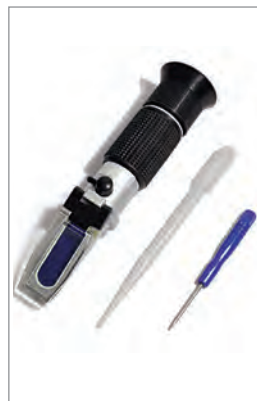
رفراکتومتر، اندازه‌گیری جرم حجمی الکترولیت
