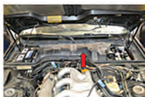
۲- پوشش پلاستیکی پایین شیشه جلو را باز کنید تا دسترسی به موتور برف پاک‌کن ممکن شود.
