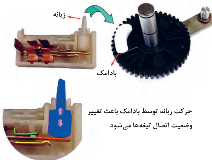
شکل ۸- کلید پارک از نوع پلاتین و بادامک
