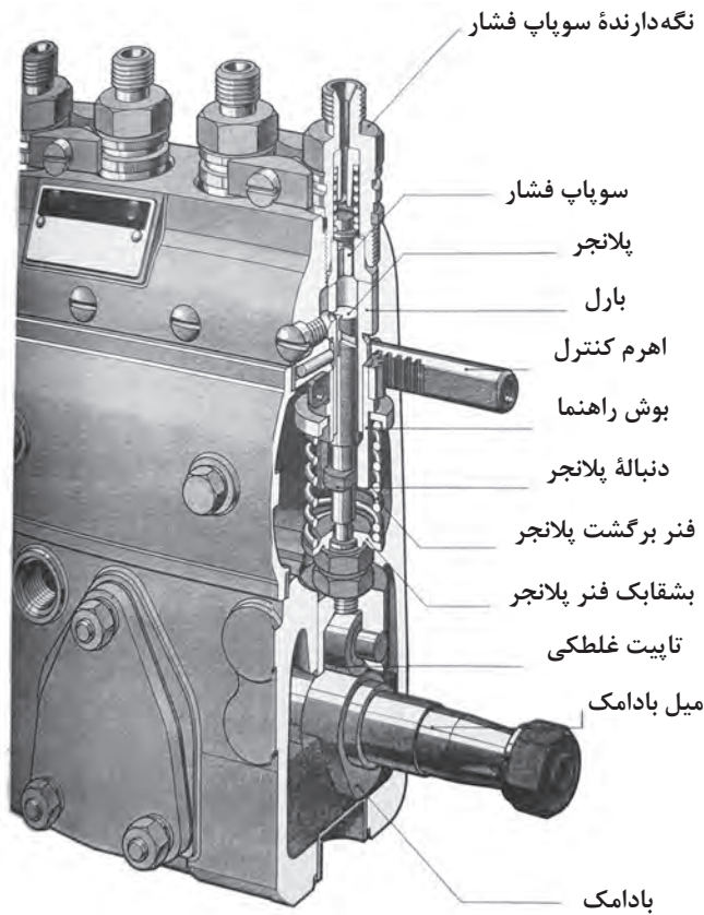
شکل ۳۱- پمپ انژکتور نوع جرک
