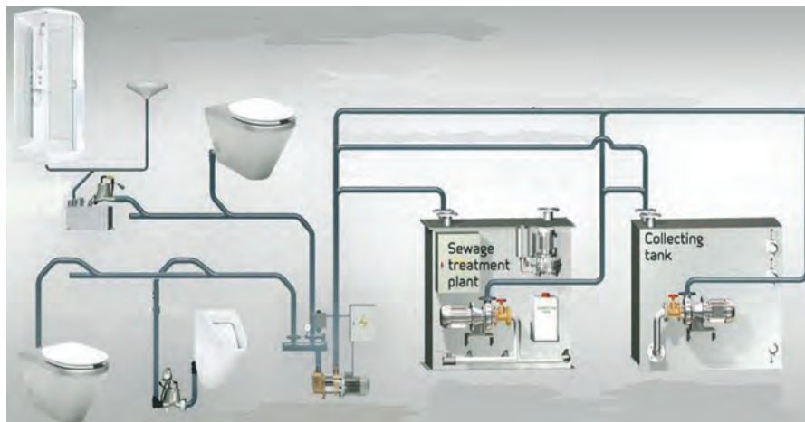
شکل ۱۴- نمودار سامانه دفع فاضلاب یک کشتی
