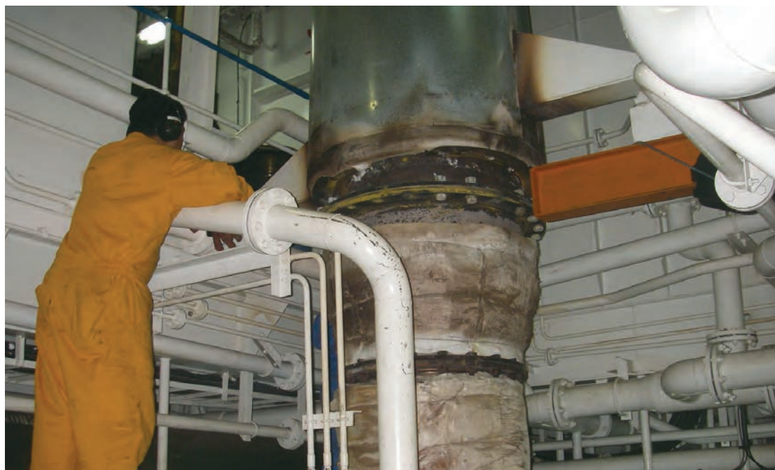
شکل ۲۷- سامانه تخلیه دود یک کشتی
