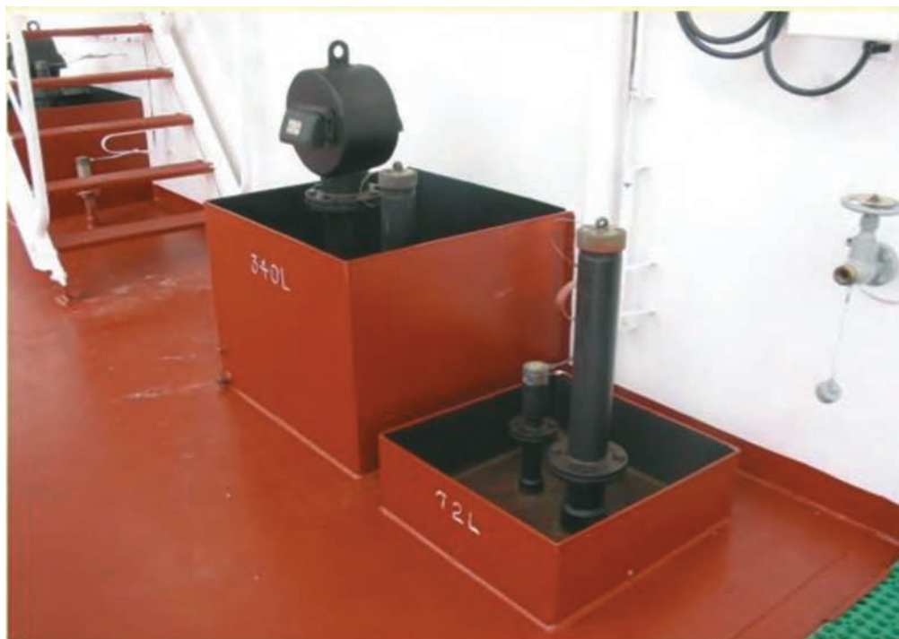
شکل ۲۵- سامانه هوا و اندازه‌گیری مخزن یک کشتی
