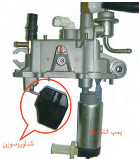
شکل ۸- مجموعه داخل مخزن تفکیک بخار
