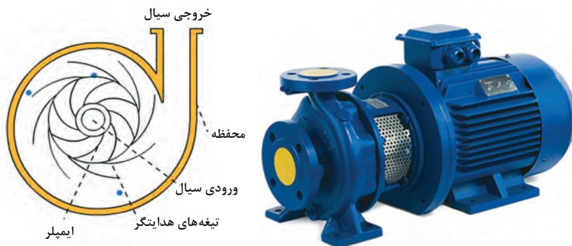
شکل ۵- پمپ گریز از مرکز
