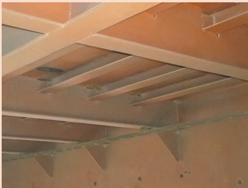
شکل ۱۸- تیرهای سقفی طولی یک کشتی در حال ساخت
