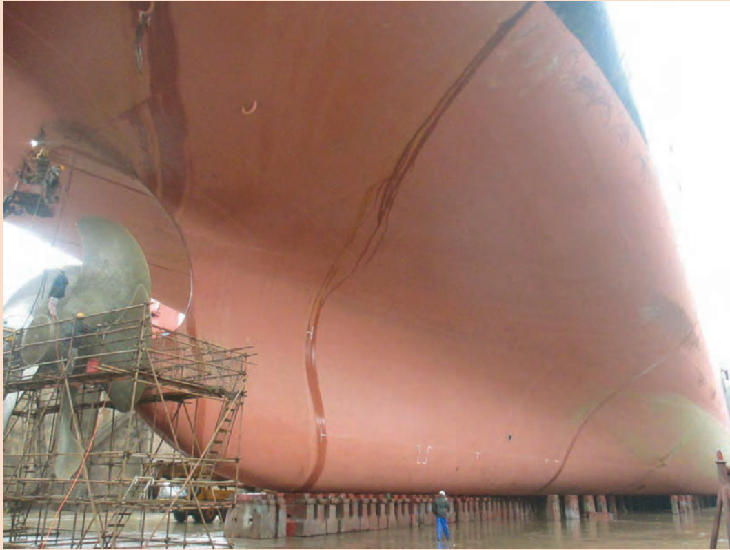
شکل ۹- تصویر شناور بر روی بلوک‌های چوبی در داخل حوضچه خشک
